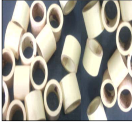
Medio empacado y de soporte de biopelícula de los DI-FAFS y TRI-FAFS.
