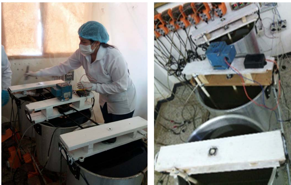
F6. Tres tanques termoagitados y temporizados de alimentación de los reactores y vista de las bombas peristálticas
