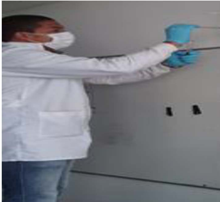
F12. Inspección visual y toma de muestra de la biopelícula adherida en los FAFA-MFS
