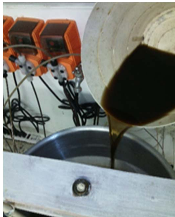
F8. Sistema de almacenamiento y bombeo de lixiviados a los reactores
