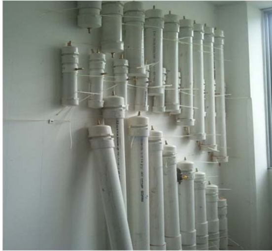
Medio empacado y de soporte de biopelícula de los DI-FAFS y TRI-FAFS.
