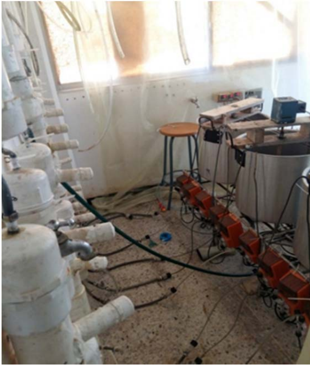
F7. Sistema de alimentación de los reactores por bombeo y vista específica de una bomba
