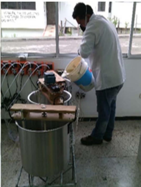
F8. Sistema de almacenamiento y bombeo de lixiviados a los reactores
