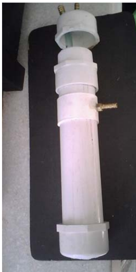
Vista vertical del separador SGL
