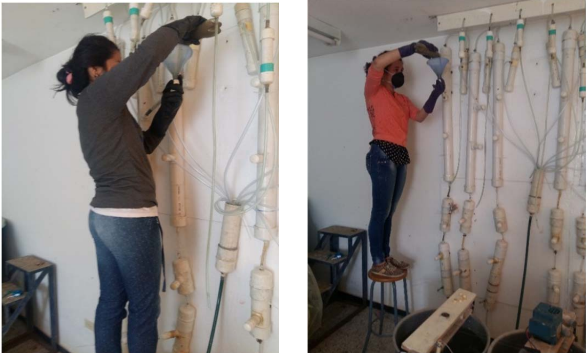
F11. Proceso de inoculación de los reactores DI-FAFS y TRI-FAFS
