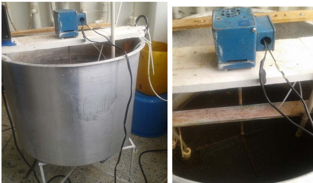
F6. Tres tanques termoagitados y temporizados de alimentación de los reactores y vista de las bombas peristálticas
