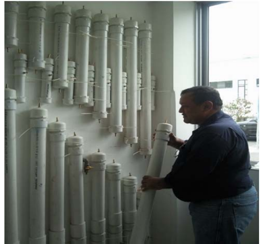
Medio empacado y de soporte de biopelícula de los DI-FAFS y TRI-FAFS.
