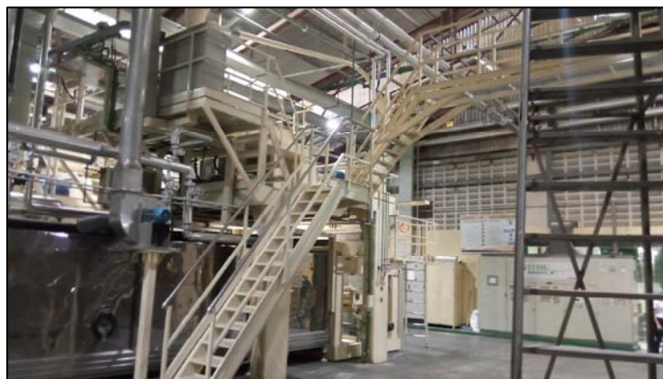
Imagen N° 3. Escalera para subir a la máquina amasadora
