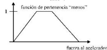
Figura 3. Función de pertenencia "menos". Eje horizontal fuerza aplicada al acelerador y eje vertical el valor de pertenencia para "menos".
