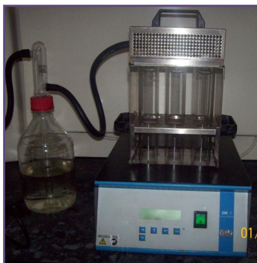
Figura 3.4 Bloque digestor marca Velp Scientifica DK6 con rampa de calentamiento
