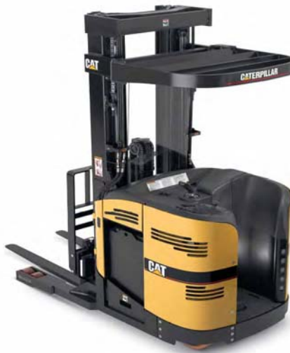
Figura 43: Montacargas electrico de horquillas no contrabalanceado de gran Altura.
