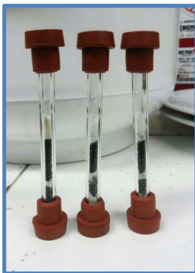
Figura 5 Dispositivos muestreadores contruidos según los requerimientos de la norma NIOSH para la realización de este trabajo de investigación.
