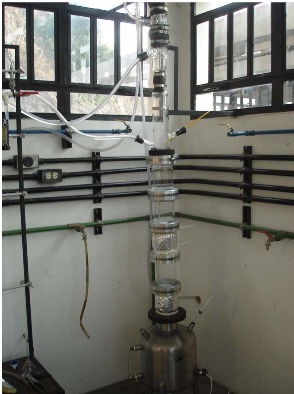
**Figura H9)** Vista de la torre de platos una vez instalada.
