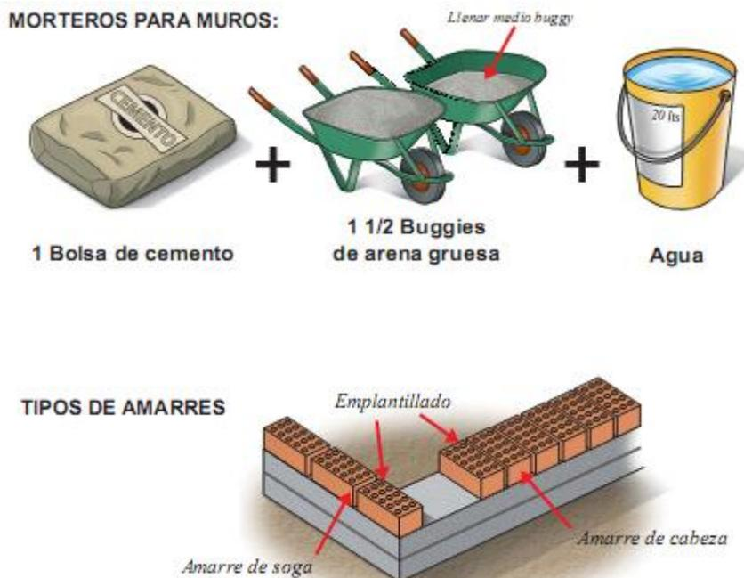
Figura 3. **Morteros para muros y tipos de Amarre.** Nota: Acerosarequica (2014)
