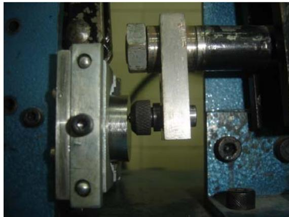
Figura 3.3. Montaje espécimen para ensayo de desgaste por frotamiento
