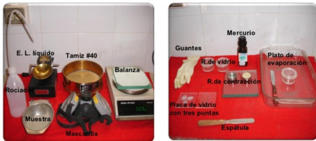
Figura Nº 9. Equipos para el ensayo Límite de Contracción
