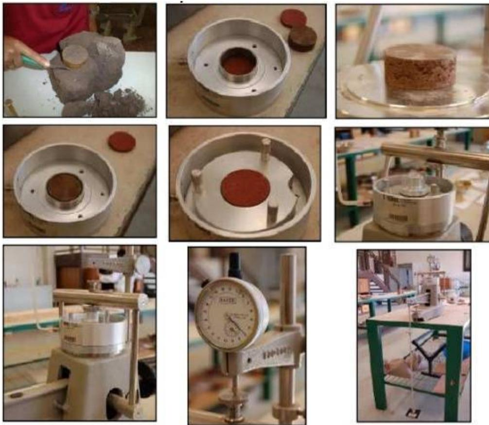
**Figura Nº 31. Ensayo de Consolidación con anillo flotante**
