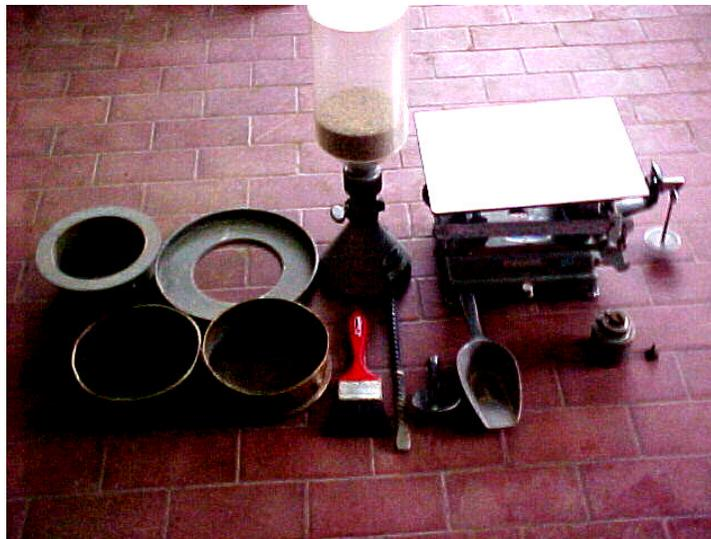
**Figura Nº 18. Equipo utilizado para el ensayo de Densidad del suelo por el cono y arena (ASTM D 1556)**
