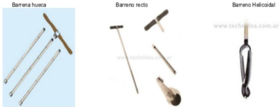
Barreno helicoidal.- La barrena helicoidal es una espiral metálica de unos 30 cm de longitud y de 3,5 a 4 cm de diámetro. La barrena helicoidal está dotada de varios barrenos, por lo general de 30 cm de longitud, que pueden ensamblarse uno a uno para tomar muestras a mayores profundidades. Algunas de las limitaciones de la barrena helicoidal son: Las muestras de suelo se alteran severamente; No es eficaz en suelos que contengan mucha arena y grava; Es difícil de usar en arcilla dura.
