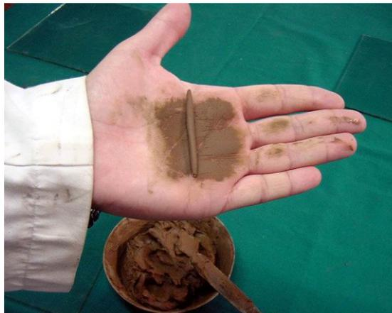
**Figura Nº 8. Ensayo de Límite Plástico en una muestra de Suelo**
