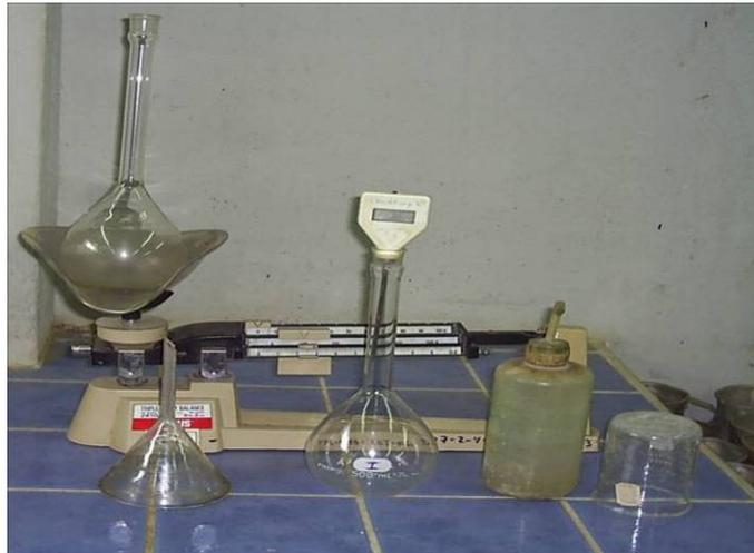
**Figura Nº 25. Equipo del Ensayo Gravedad Específica del suelo**
