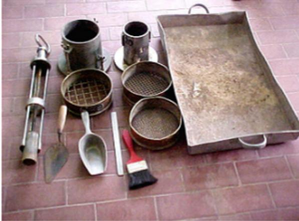
**Figura Nº 13. Equipos del Ensayo de Compactación**
