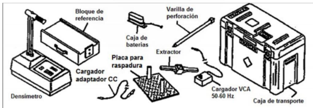
Figura Nº 21. Equipo y accesorio usado en el Densímetro Nuclear
