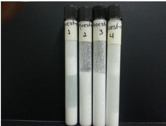
**Figura 28.** Montaje realizado para determinar la sedimentación de sólidos.
