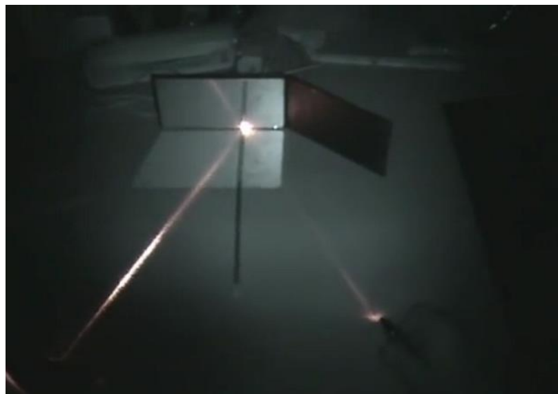
Figura N° 2. Rayo de luz reflejado en un espejo plano
