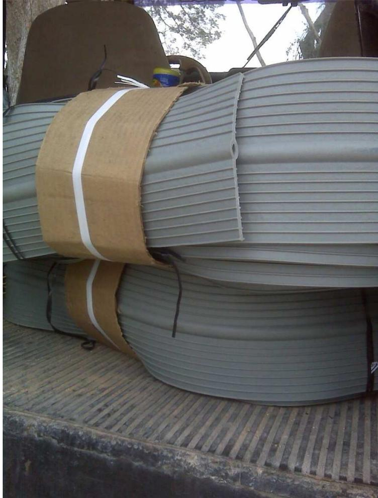
*Figura 26.* **Juntas de PVC de un bulbo en junta de construcción.** *Nota.* Pottellá Tulio (2011)
