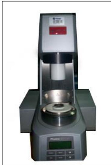
**Figura 3.6.** Reómetro modelo PHYSICA MCR 30, marca Anton Paar.
