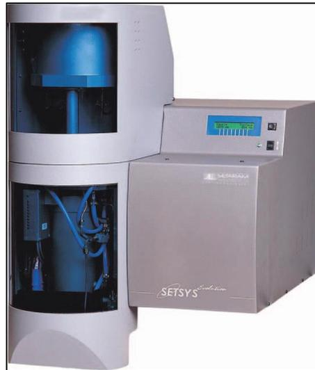
**Figura 3.3.** Termobalanza modelo SETSYS Evolution TGA, marca SETARAM Instruments.
