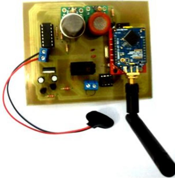
**Figura 4.11:** Montaje del sistema de comunicación sobre una tarjeta de circuito impreso (PCB)
