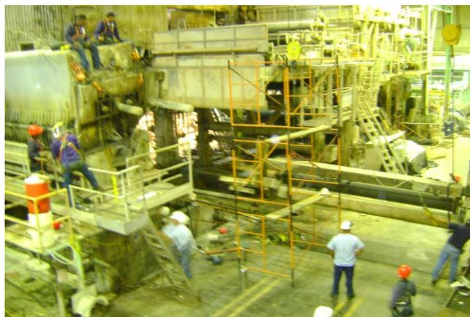
Figura N° 63. Desmontaje de rodillo inferior sección prensa.
