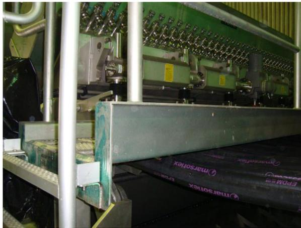
Figura N° 146. Conexión de mangueras tubo de alimentación a la caja de entrada
