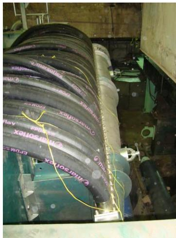
Figura N° 132. Montaje tubo alimentación caja de entrada.
