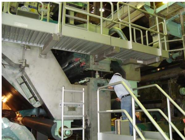
Figura N° 144. Ajustes de los tensores del fieltro en CT2-CT3.
