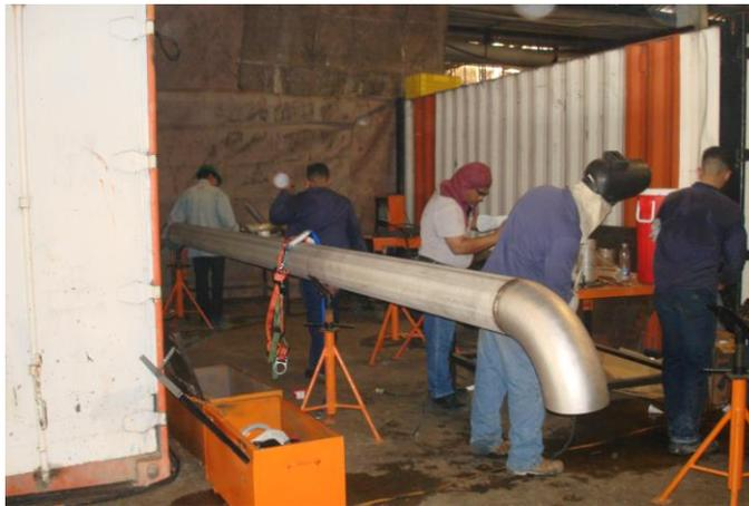
Figura N° 37. Prefabricación de tuberías y soportes.
