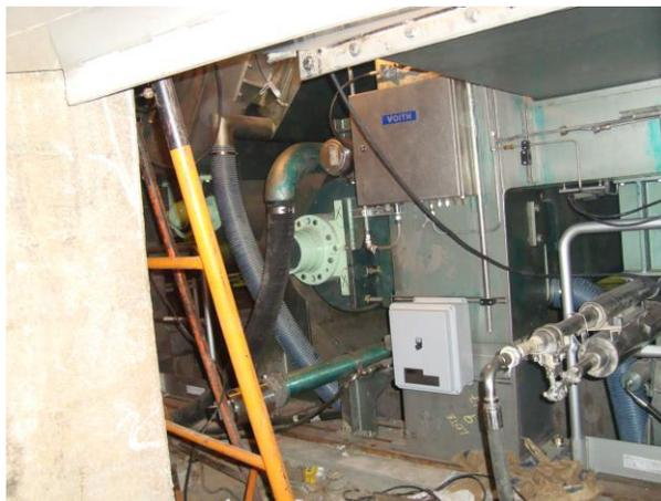
Figura N° 147. Conexión de las mangueras de las duchas tela y fieltro.
