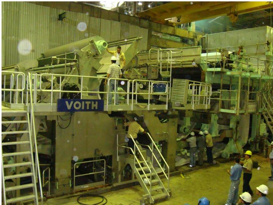
Figura N° 150. Ajustes e instalación de vestiduras.
