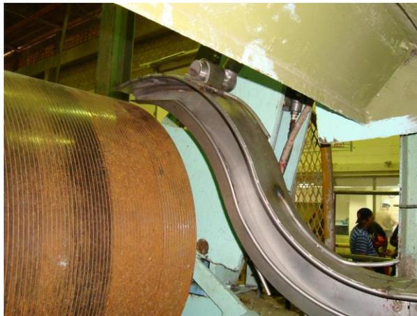
Figura N° 92. **Montaje del ducto de entrega de hoja sobre el reel.**
