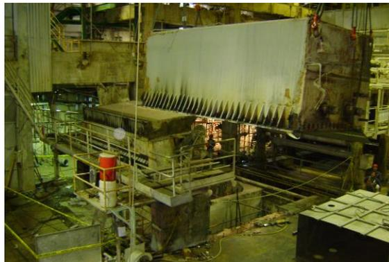
Figura N° 55. **Desmontaje de parte superior caja de entrada.**
