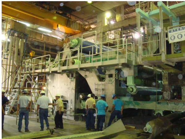
Figura N° 135. Montaje del rodillo fieltro 4.02
