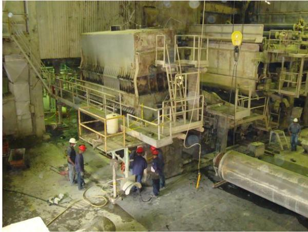
Figura N° 53. **Desmontaje de rollo pecho.**
