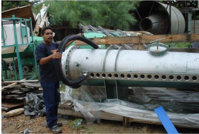
Figura N° 42. **Pre-ensamblaje de mangueras en tubo de alimentación a caja entrada.**
