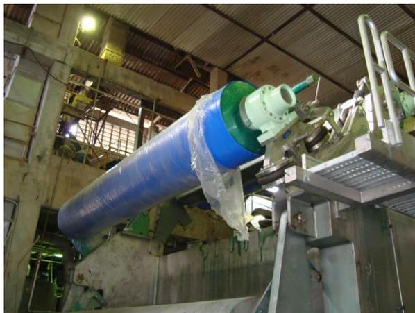
Figura N° 126. **Montaje del rodillo tela 2.04.**
