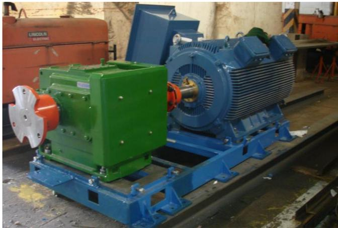
Figura N° 40. **Pre-ensablaje de accionamiento rolo formador.**
