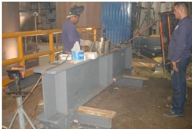
Figura N° 35. Fabricación de mecanismos para movilización de cargas principales.
