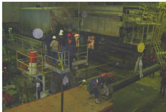
Figura N° 62. Desmontaje de rodillo superior sección prensa.
