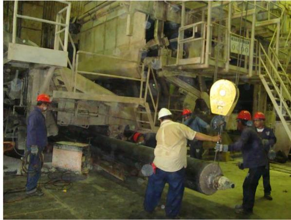
Figura N° 58. **Desmontaje de rodillos de mesa inclinada máquina fourdrinier**
