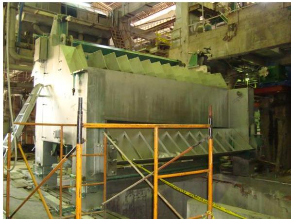
Figura N° 120. Ubicación del monobloque sobre los rieles de carga.
