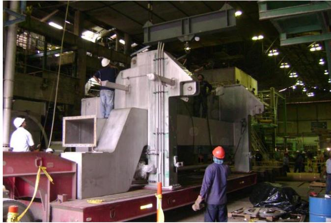
Figura N° 118. Anclaje del dispositivo giratorio al monobloque.
