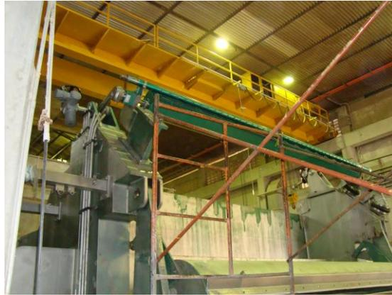
Figura N° 121. **Montaje del raspador del rodillo tela 2.04**
