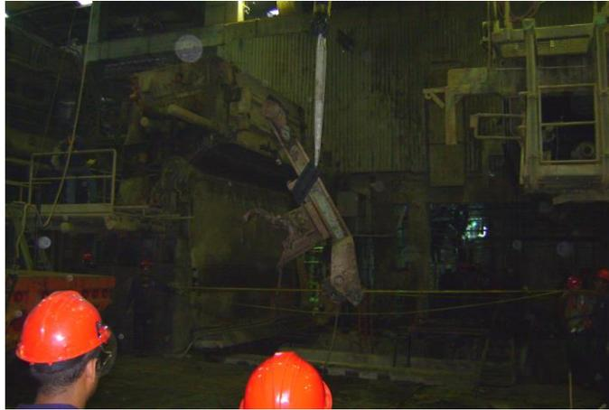
Figura N° 64. **Desmontaje de soportes de brazos laterales.**
