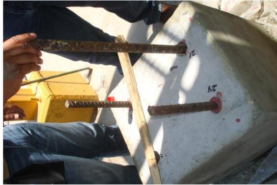
Figura N° 33. Muestra a ensayar de anclajes usando producto para anclaje especificado.
