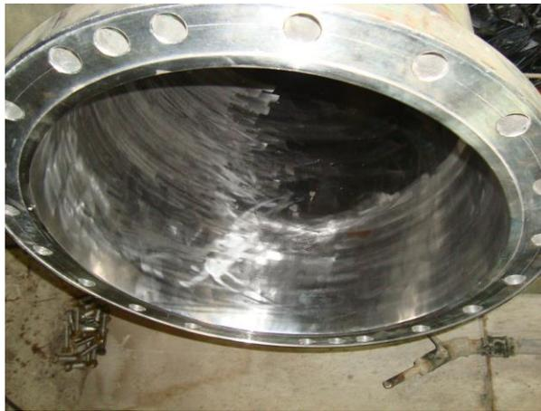
Figura N° 143. Tubería de aproximación para instalación con pulimento interno de cordones
