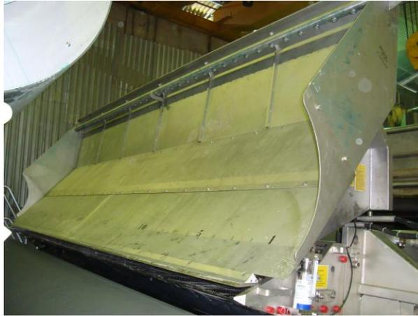
Figura N° 145. Instalación de la caja de entrada.
