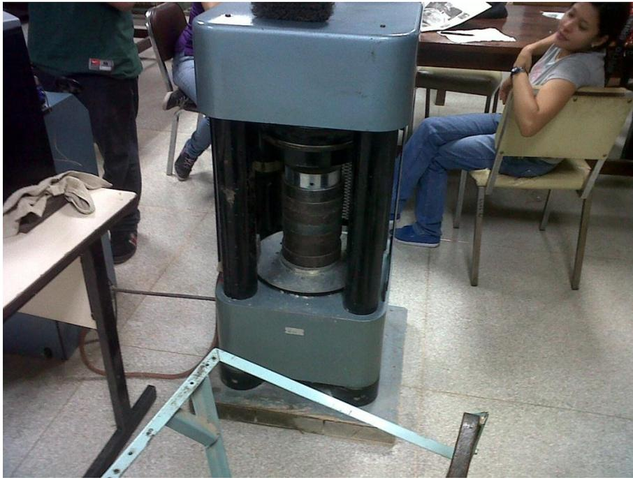
Figura 18. Prensa hidráulica para el ensayo de compresión.
