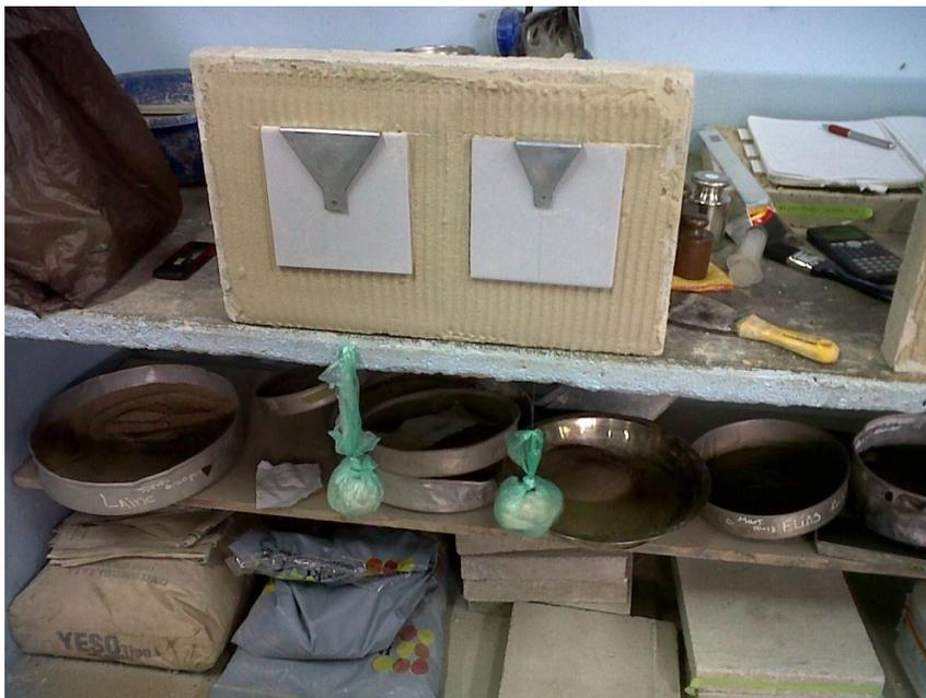
Figura 3. Colocación de pesas de 300 gr. sobre cada probeta para medir deslizamiento
