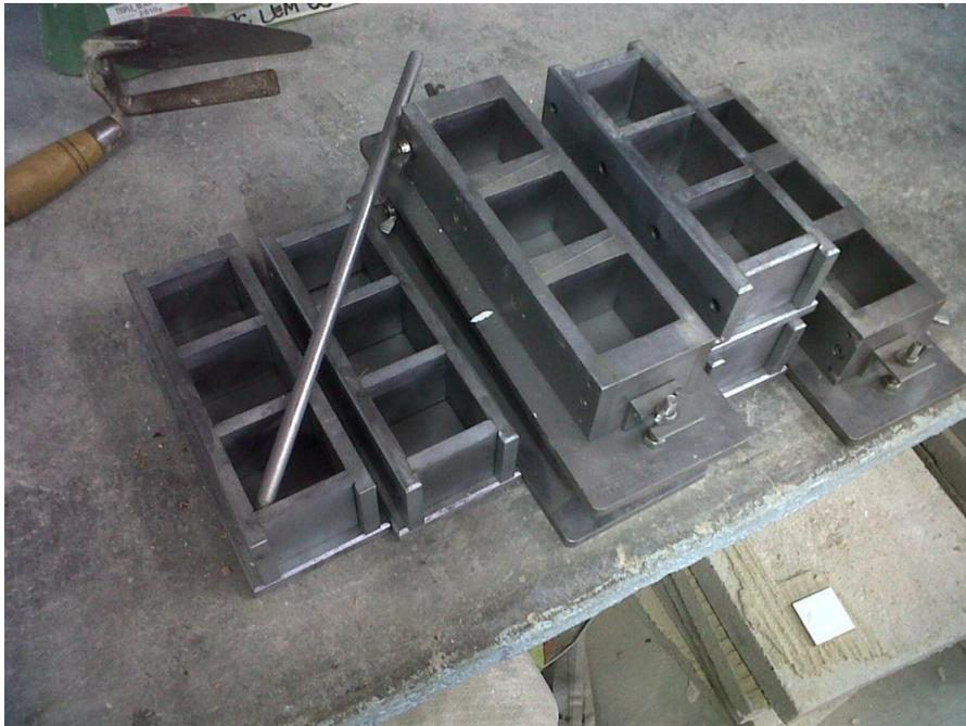
Figura 17. Moldes y barra compactadora, utilizados para la elaboración de las probetas cúbicas
