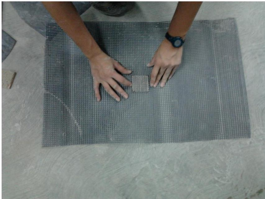
Figura 7. Medición de la cantidad de mortero adherido en las probetas
