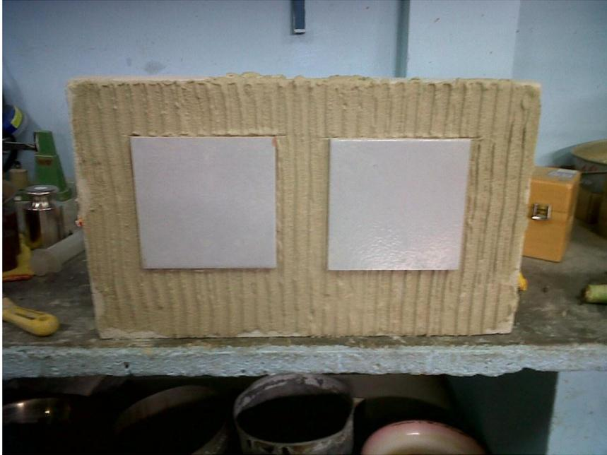
Figura 2. Placa colocada en posición vertical durante 10 min.
