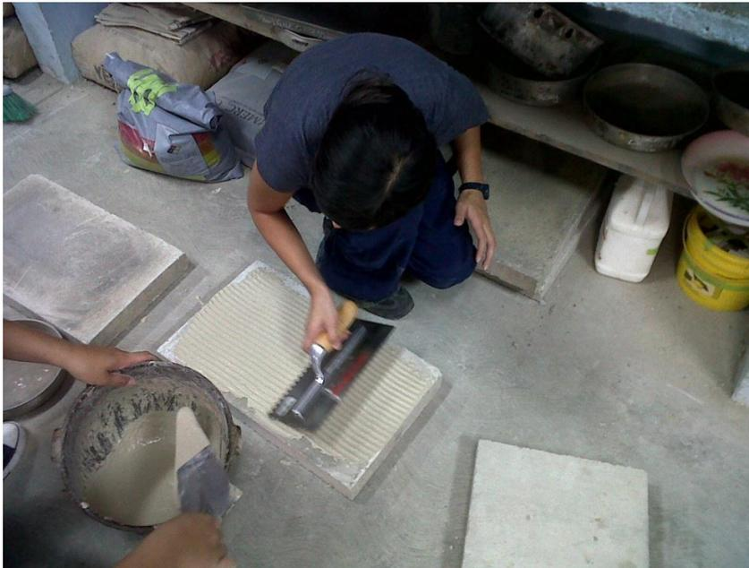
Figura 5. Extendido del mortero sobre las placas de concreto
