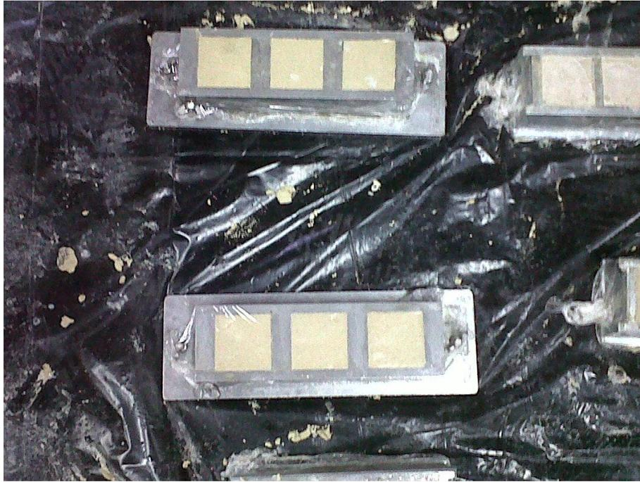
Figura 20. Moldes cubiertos con polietileno para el curado de las probetas por 24 horas.
