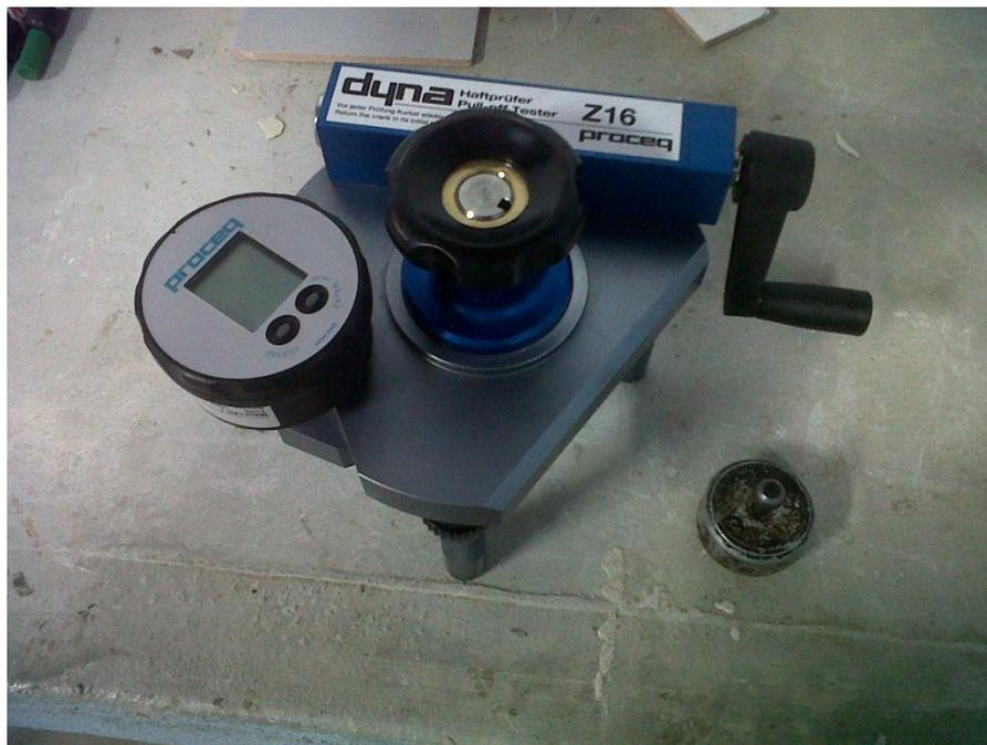
Figura 14. Máquina de tracción utilizada en el ensayo de adherencia.
