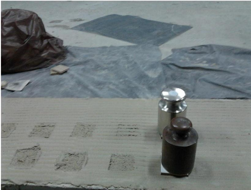
Figura 6. Colocación de pesas de 2 Kg sobre las probetas durante 30 seg.
