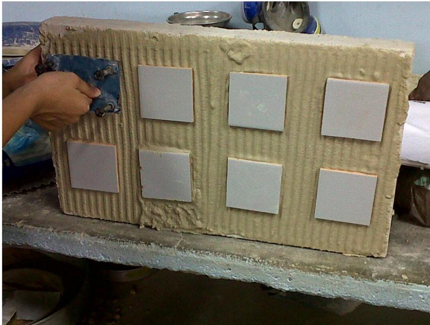
Figura 10. Colocación de la herramienta para girar cada probeta  $90^\circ$ . Ensayo de la primera fila de probetas
