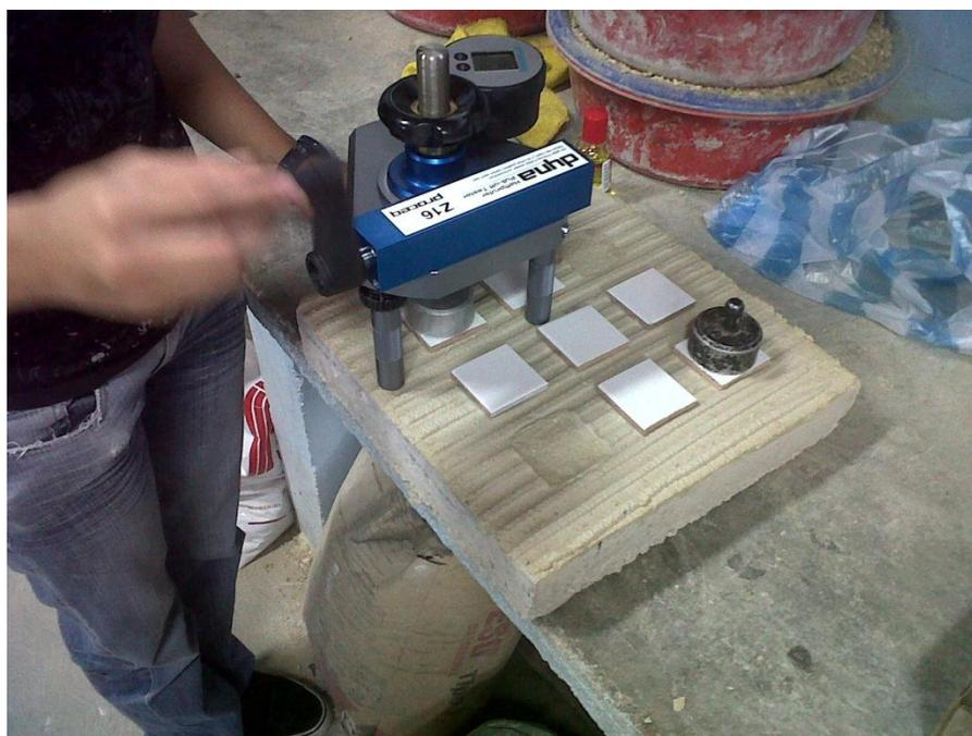
Figura 15. Utilización del equipo de tracción para determinar la resistencia al despegue de cada probeta
