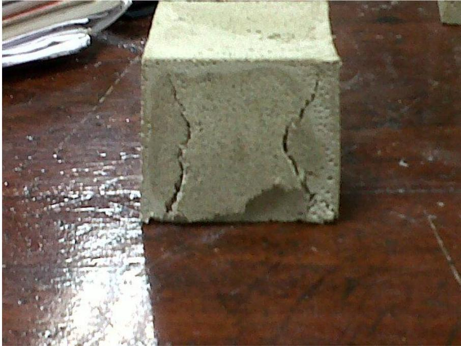
Figura 22. Probeta cúbica luego de haber sido sometida a compresión.
