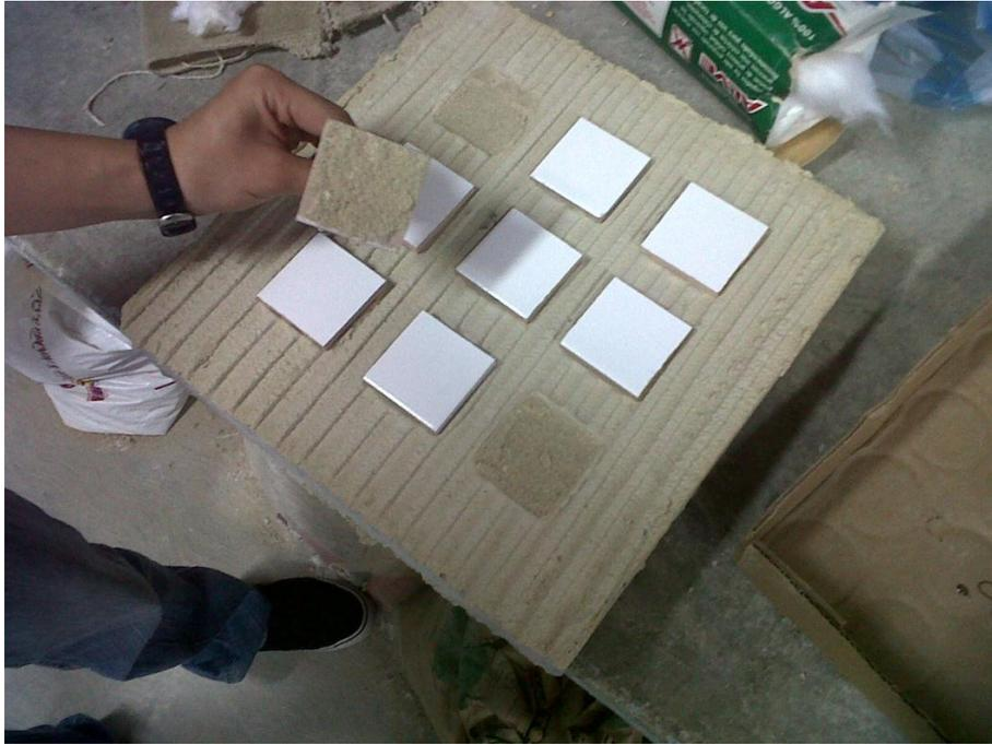
Figura 16. Muestra de placa con probeta ya arrancada.
