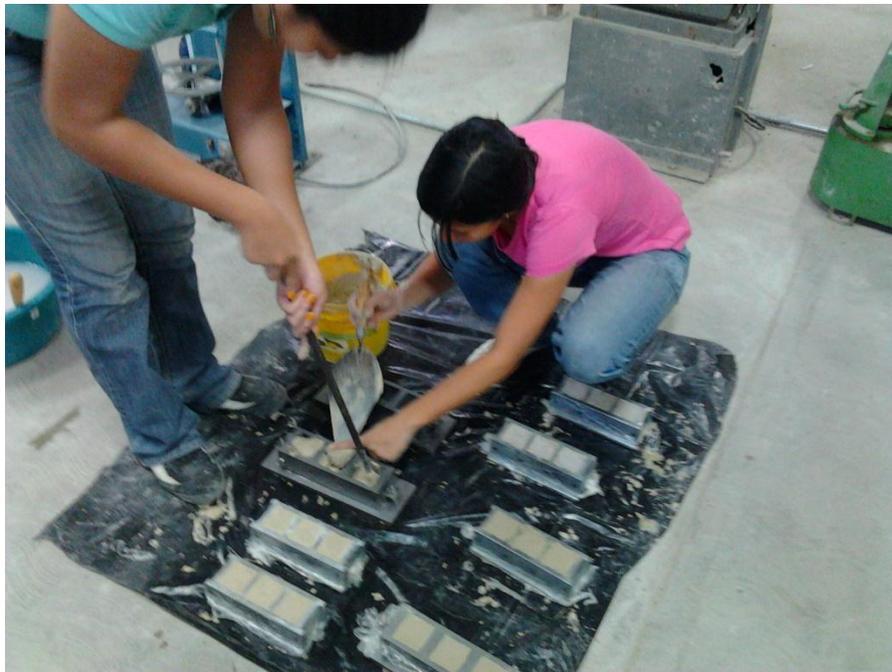
Figura 19. Colocación y compactación de las capas de mortero en los moldes
