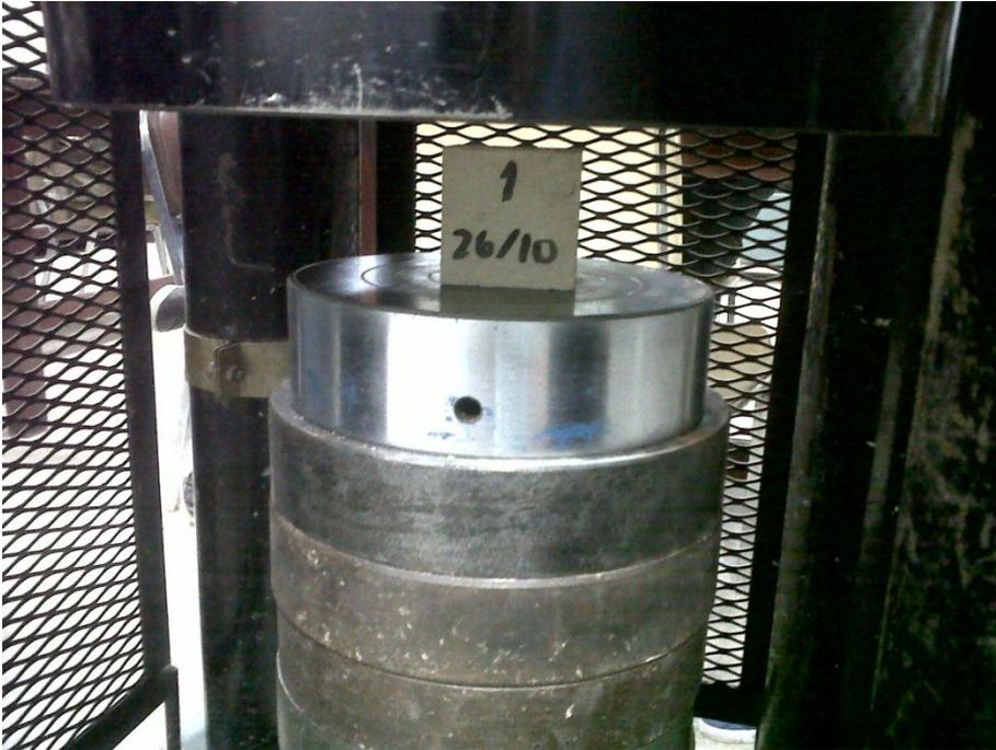
Figura 21. Colocación de la probeta en la prensa hidráulica para realizar el ensayo.
