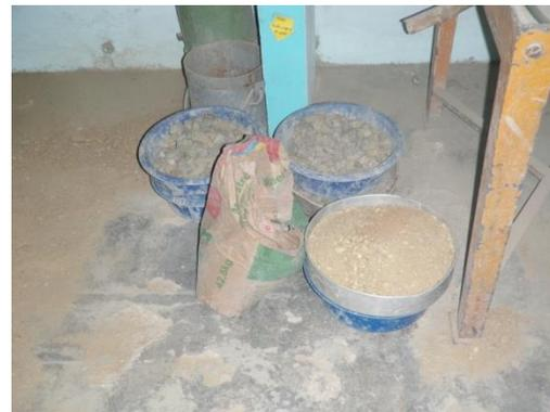
Agregados y Cemento pesados justo antes de ser mezclados en el Trompo.
