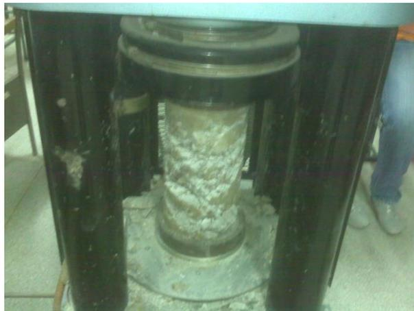
Cilindro No compactado siendo ensayado en la Maquina de Compresión Axial
