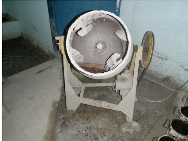
Mezcladora de Eje Horizontal (Trompo).
