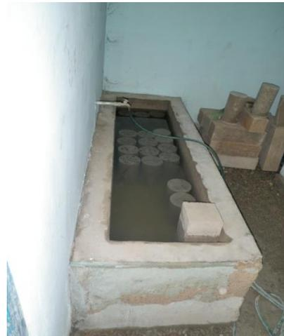
Cilindros en Proceso de Curado.
