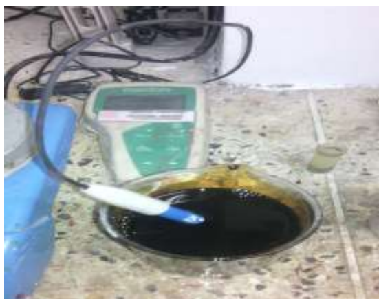
Figura 4.5 Medición del pH para constatar el fin de la reacción de oxidación de la glucosa
