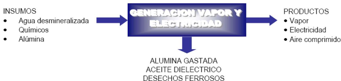
**Figura. Flujograma de la Planta de Generación de Vapor y Electricidad.**
