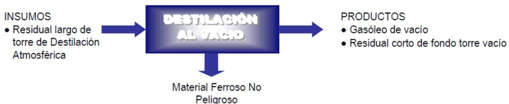
**Figura. Flujograma de Destilación al vacío.**
