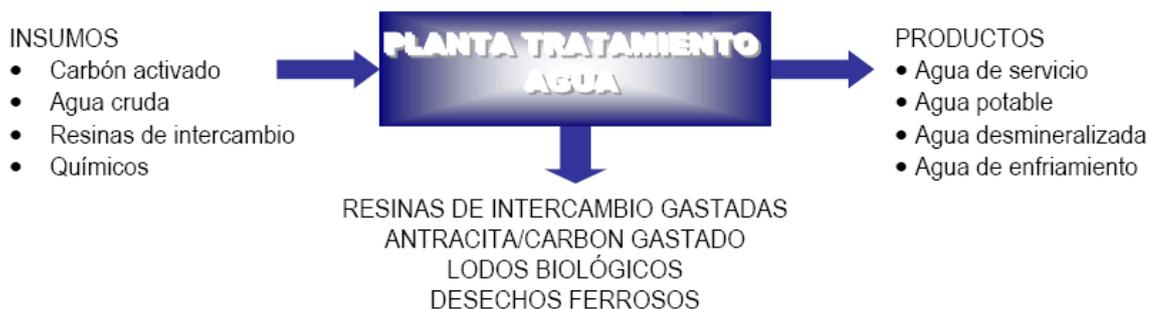
**Figura. Flujograma de la Planta de Agua.**
