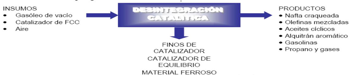
**Figura. Flujograma de Craqueo Catalítico Fluidizado FCC.**
