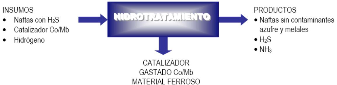
**Figura. Flujograma de Hidrotratamiento de nafta**
