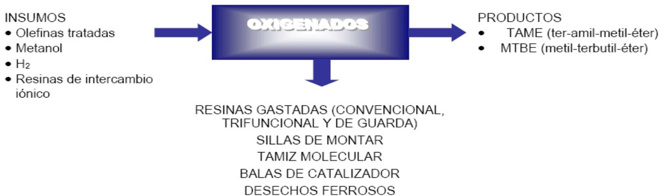
**Figura. Flujograma de la planta de oxigenados.**
