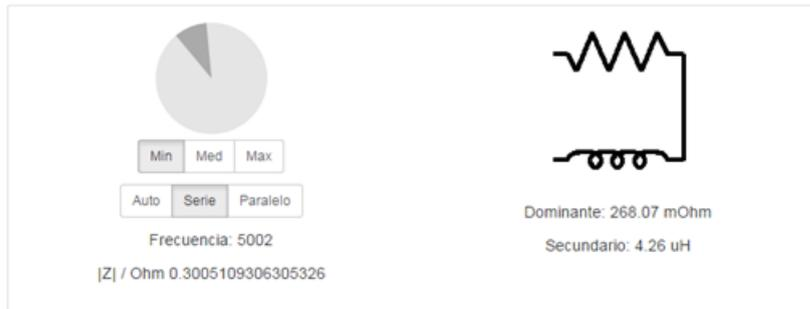
**Figura 4.32:** Equivalente Serie de la Inductancia medida en la aplicación LCR.
