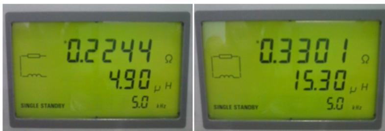
**Figura 4.34:** Inductancia Serie y Paralelo medida a través del RCL METER (FLUKE) PM6306. Fuente: propia
