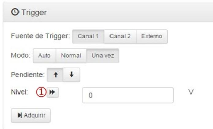
Figura 3.17: Panel de configuración del Trigger. Fuente: propia
