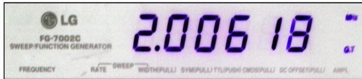
**Figura 4.52:** Generador de funciones a 2MHz. Fuente: propia
