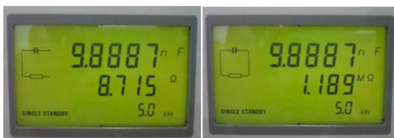
**Figura 4.30:** Capacitancia Serie y Paralelo medida a través del RCL METER (FLUKE) PM6306. Fuente: propia
