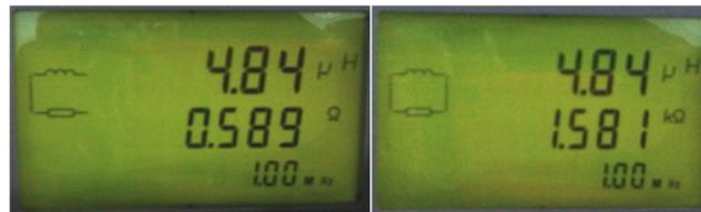
**Figura 4.43:** Inductancia serie y paralelo medida a través del RCL METER (FLUKE) PM6306. Fuente: propia
