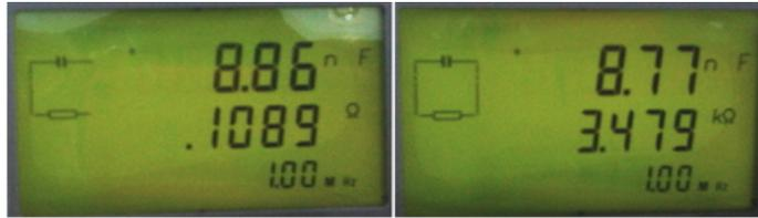
**Figura 4.40:** Capacitancia serie y paralelo medida a través del RCL METER (FLUKE) PM6306. Fuente: propia
