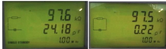
**Figura 4.37:** Resistencia serie y paralelo medida a través del RCL METER (FLUKE) PM6306. Fuente: propia
