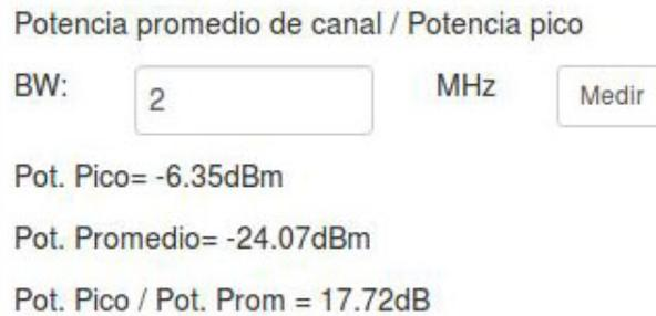
**Figura 4.69:** Relación de potencia promedio de canal vs potencia pico
