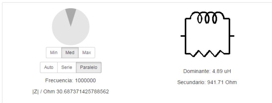
**Figura 4.42:** Equivalente Paralelo de la Inductancia medida en la aplicación LCR. Fuente: propia
