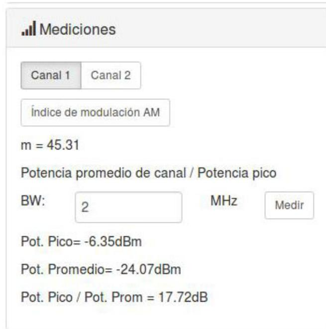
**Figura 3.35:** Panel de mediciones - Analizador de espectros
