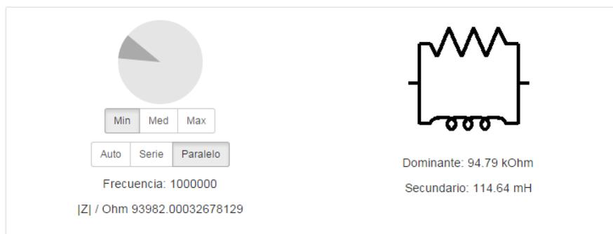
**Figura 4.36:** Equivalente Paralelo de la Resistencia medida en la aplicación LCR.
