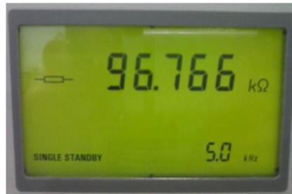
**Figura 4.26:** Resistencia medida a través del RCL METER (FLUKE) PM6306. Fuente: propia
