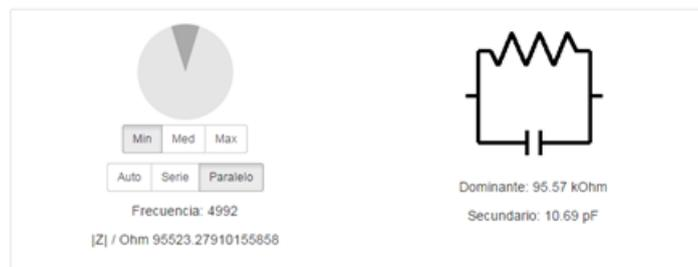
**Figura 4.25:** Equivalente Paralelo de la Resistencia medida en la aplicación LCR. Fuente: propia
