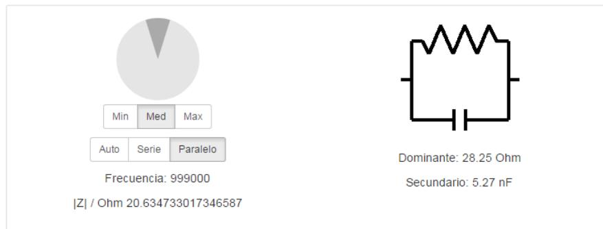
**Figura 4.39:** Equivalente Paralelo de la Capacitancia medida en la aplicación LCR. Fuente: propia
