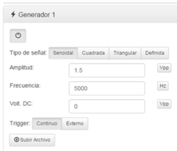
**Figura 4.18:** Generación de señal senoidal desde la aplicación Osciloscopio + Generador UC. Fuente: propia
