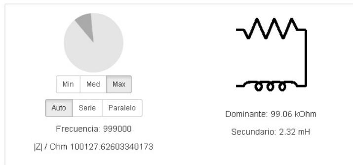
**Figura 4.35:** Equivalente Serie de la Resistencia medida en la aplicación LCR.
