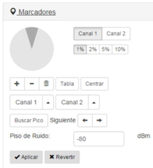
**Figura 3.33:** Panel de Marcadores - Analizador de espectros. Fuente: propia
