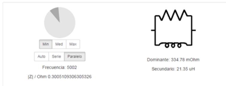
**Figura 4.33:** Equivalente Paralelo de la inductancia medida en la aplicación LCR.
