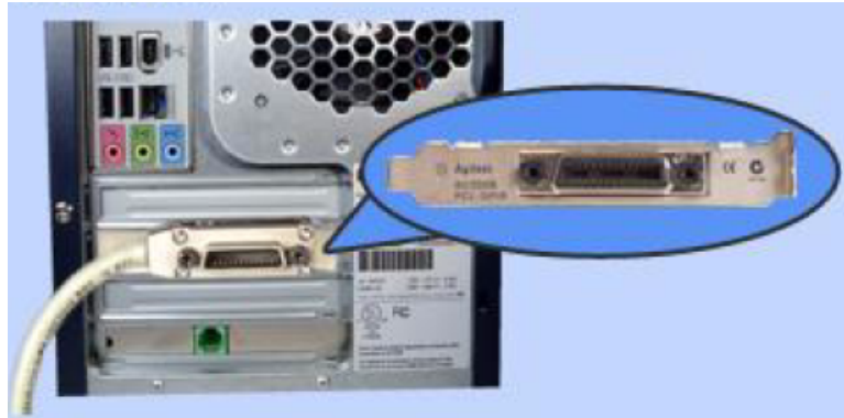
Figura 3.3: Tarjeta Agilent 82350B instalada en un computador y cable de terminación GPIB-GPIB.
