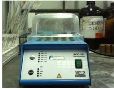
**Figura 3.2. Equipo empleado para la digestión de las muestras en el LEPA**
