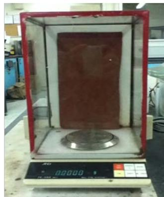
**Figura 3.6. Balanza analítica digital del LEPA**
