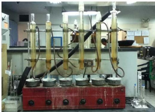
**Figura 4.7. Equipo de reflujo abierto del LEPA**
