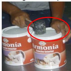
Figura N° 50. Riesgo de la operación de tapado
