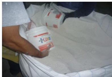
Figura N° 32. Dificultad de extracción de material del Big-Bag
