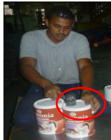
Figura N° 48. Colocación de la tapa manualmente
