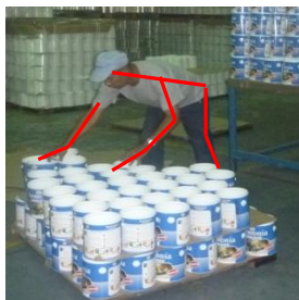
Figura N° 61. Operario del área de suministro armando paleta de galones
