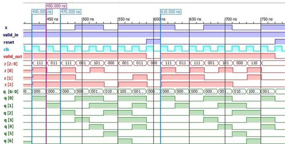
Figura 4.5: Simulación en Modelsim del codificador convolucional LTE. Fuente: Propia
