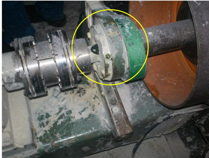
Figura N° 18. Drenaje de lubricante por los laterales del rodamiento
