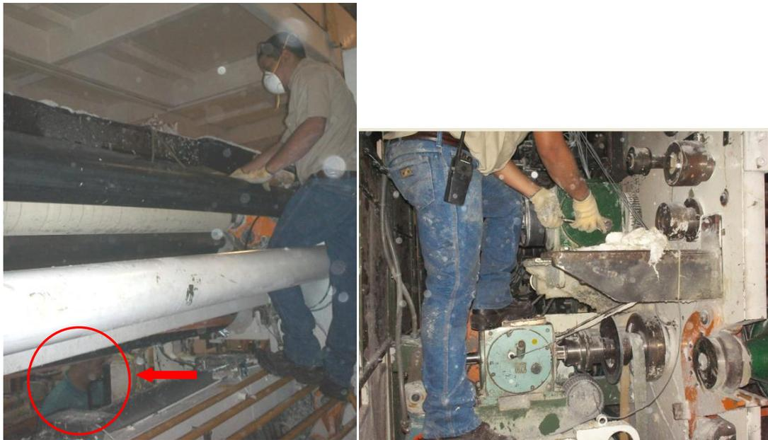
Figura N° 20: Lubricación de los puntos a una altura mayor a 2,20 m
