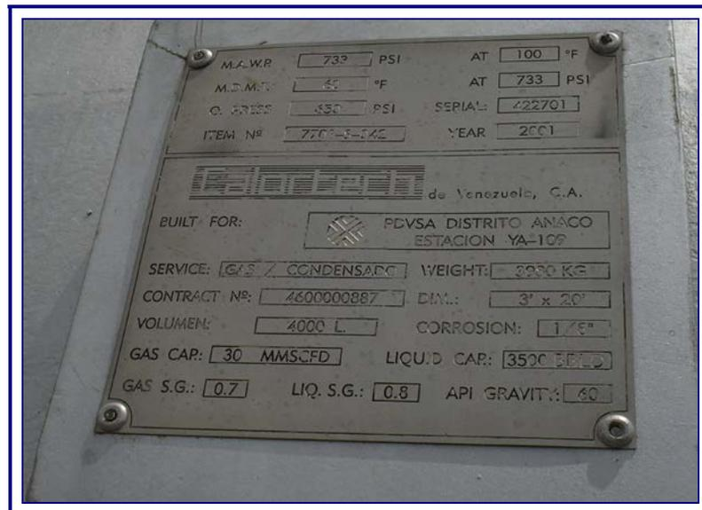
**Figura A.12** Datos de placa de diseño
