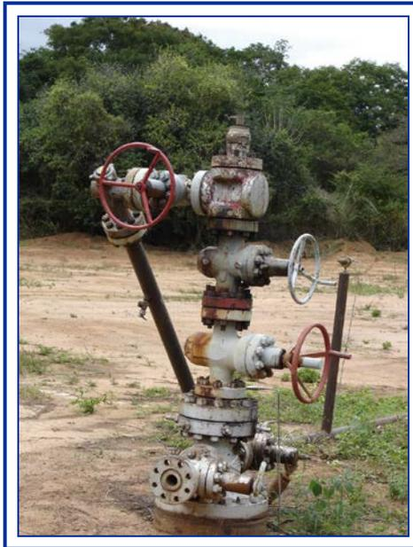
**Figura 3.1** Cabezal de pozo
