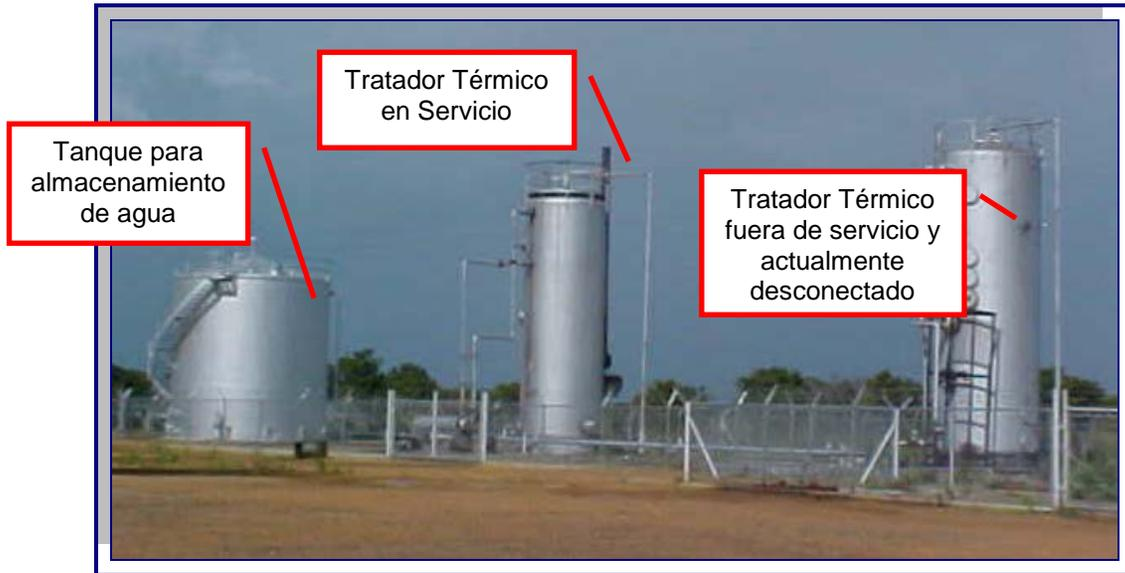
**Figura A.1** Disposición de equipos de almacenamiento y tratamiento
