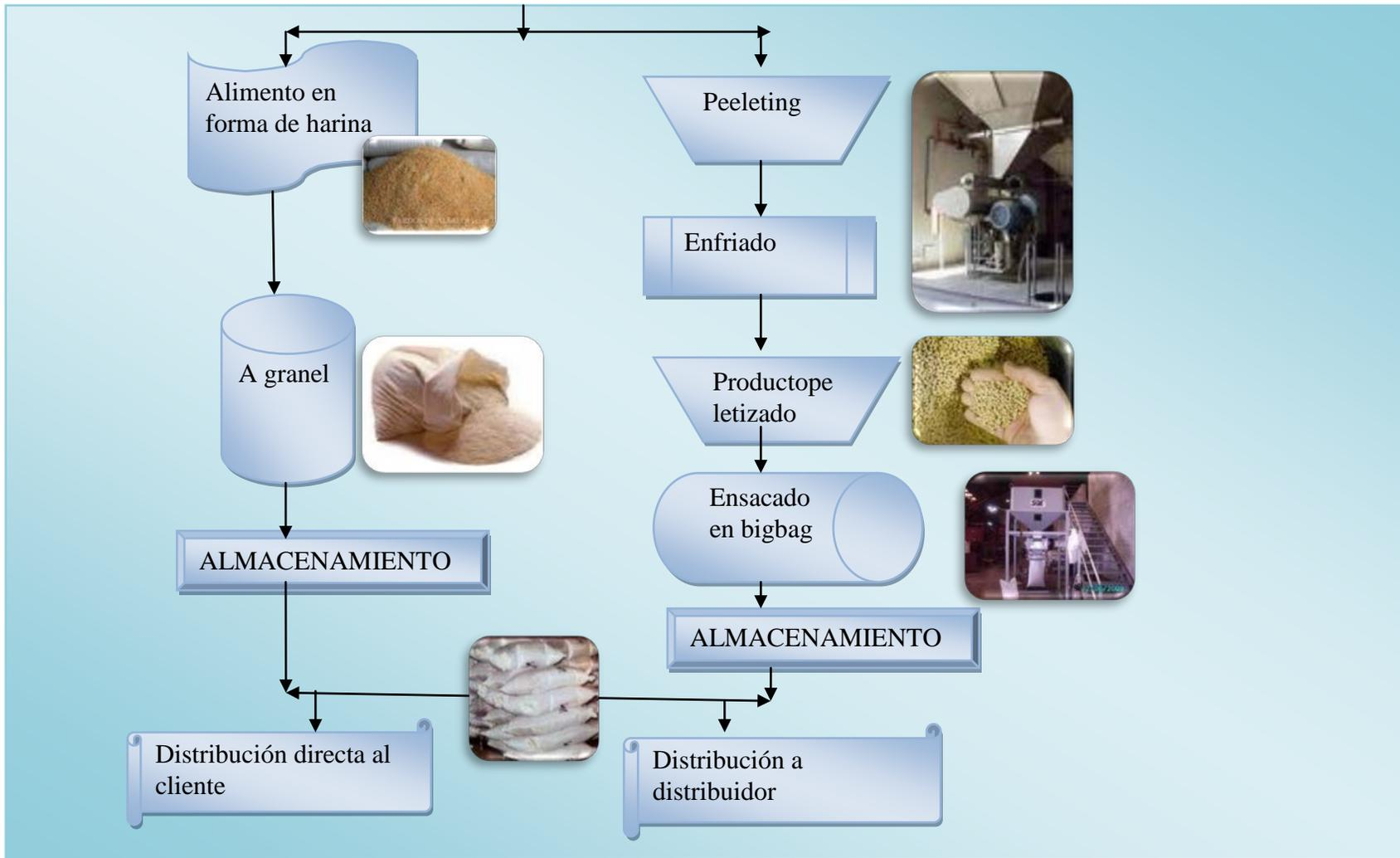
**Figura 4.2** Diagrama general de la producción de alimento concentrado para cerdas productoras de Granjas Alconca C.A (Continuación)
