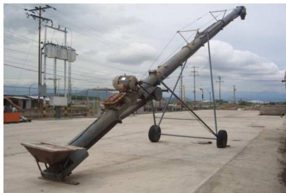
**Figura 1.1.** Transportador de banda tipo bazuca (Investigador).
