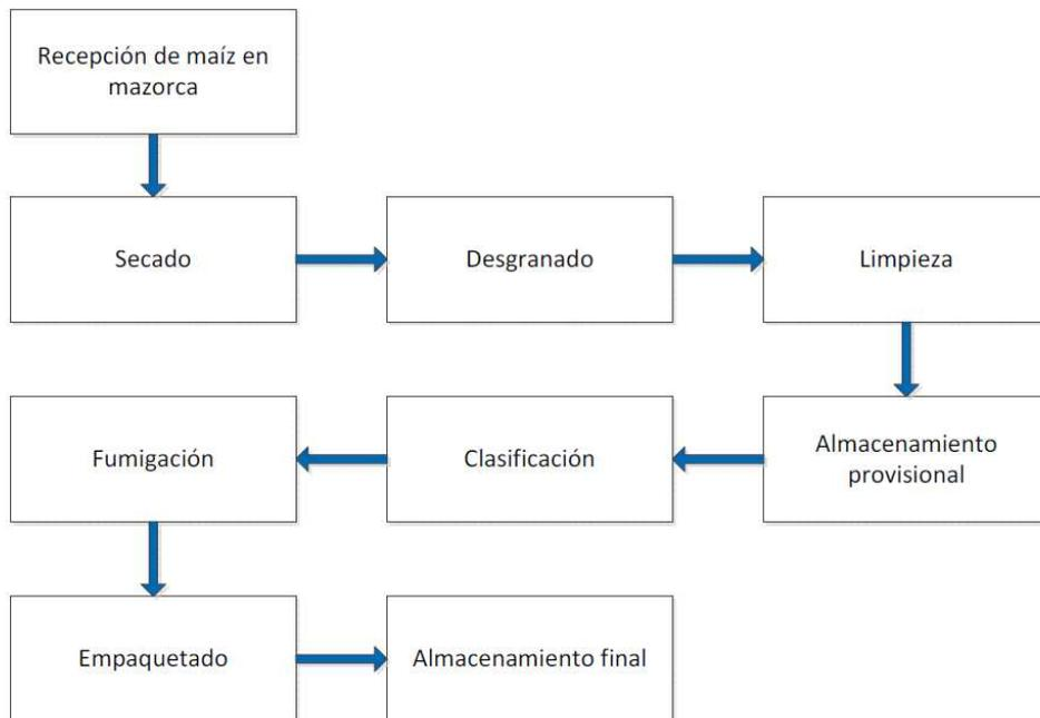
**Figura B3.** Diagrama de proceso de maíz en mazorca.
