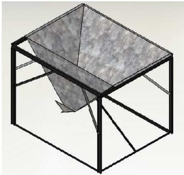
**Figura 4.19** Diseño de la tolva de recepción y estructura de soporte
