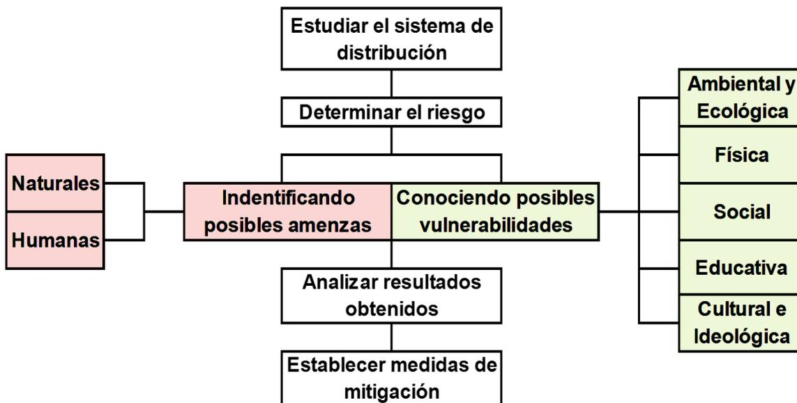
**Figura N° 17.** Esquema para establecer medidas de mitigación de riesgos.
