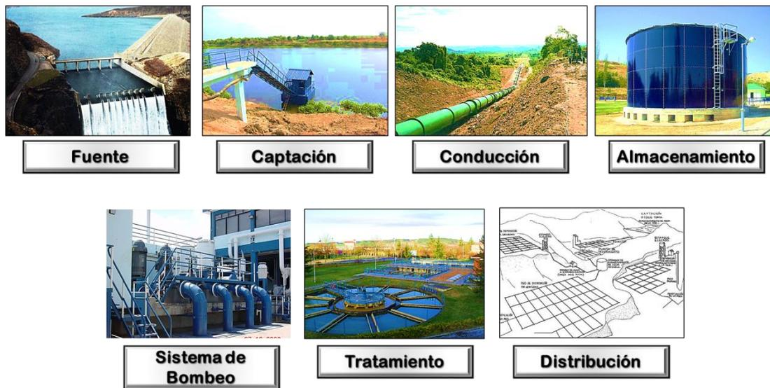
**Figura N° 1.** Sistema de abastecimiento de agua. Componentes Básicos.
