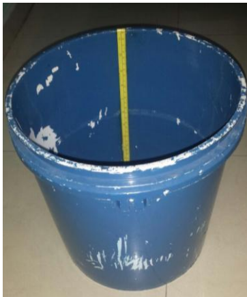
Figura 4. Tobo para la medición de caudal variable. Fuente: Los autores
