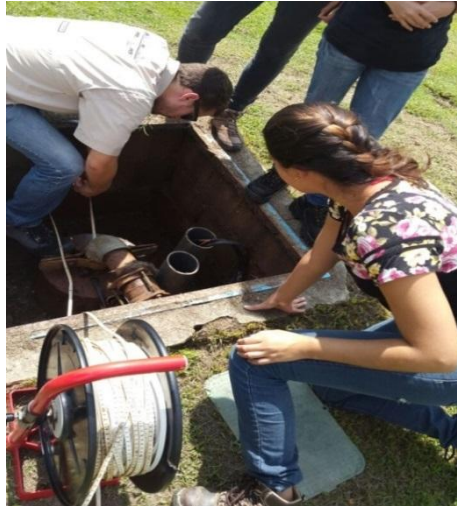
Figura 14. Medición de nivel en el Pozo # 3 de Villas de San Diego Country club. Coordenadas 615.974,25 E; 1.137.460,67 N, elevación 495 m.s.n.m, Municipio San Diego, Estado Carabobo. Fecha: 22/09/2016. Fuente: Los Autores
