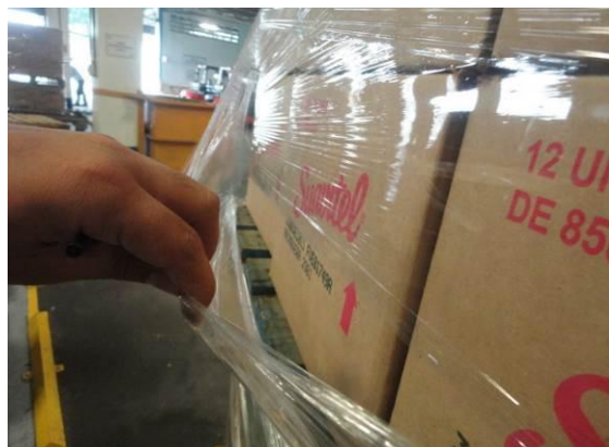
Figura Nro. 23 Déficit de Tensión en la envoltura de paletas
