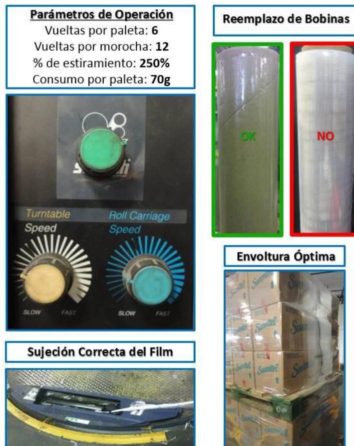
Figura Nro. 37 Control visual para máquinas envolvedoras Lantech
