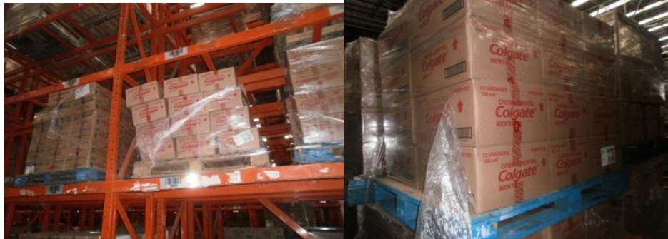
Figura Nro. 25 Almacenamiento inadecuado por desprendimiento de polystrech.
