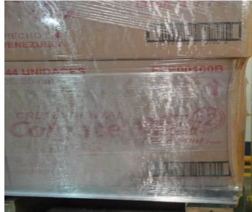
Figura Nro. 22 Exceso de Tensión en la Envoltura de Paletas
