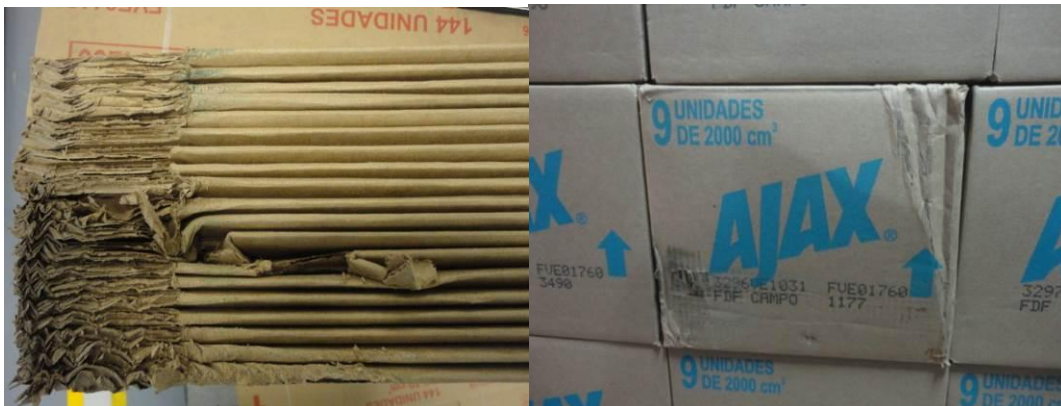
Figura Nro. 16 Condiciones del corrugado defectuoso
