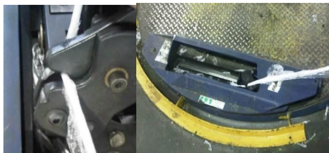
Figura Nro. 26 Forma correcta de sujetar el polystrech
