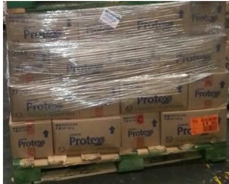
Figura Nro. 27 Forma incorrecta de envoltura
