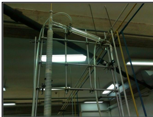
Figura 3.11. Sistema de purificación de solvente (torre de destilación con condensador horizontal).
