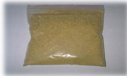
**Figura 3.3** Biomasa después del proceso de molienda y tamizado.
