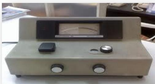
**Figura 3.14**Equipo Visible Spectronic 20.
