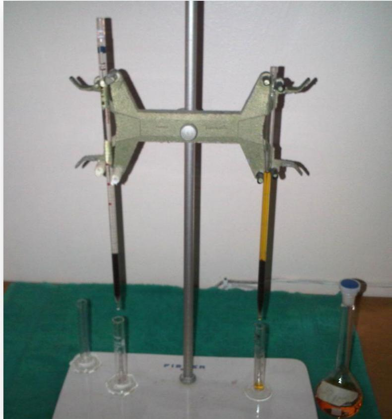
**Figura 4.2.1** Montaje del sistema de adsorción
