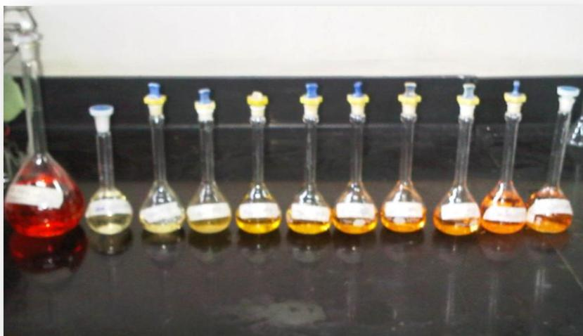
**Figura 3.12** Soluciones de diferente concentraciones de la solución madre de naranja de metilo.
