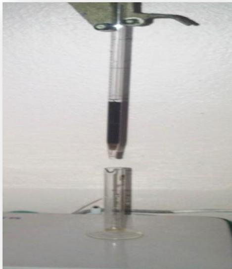
**Figura 3.11** Montaje del diseño de adsorción dinámica.
