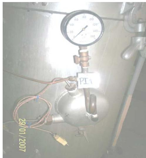
Instrumentos de medición de variables controlables del Autoclave
