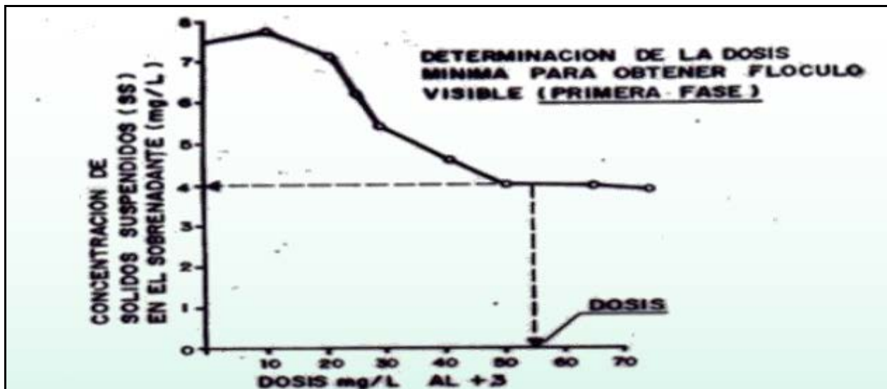
Figura 3.6 Valores de turbidez para cada concentración de sulfato de aluminio dosificada en la prueba de jarras.
