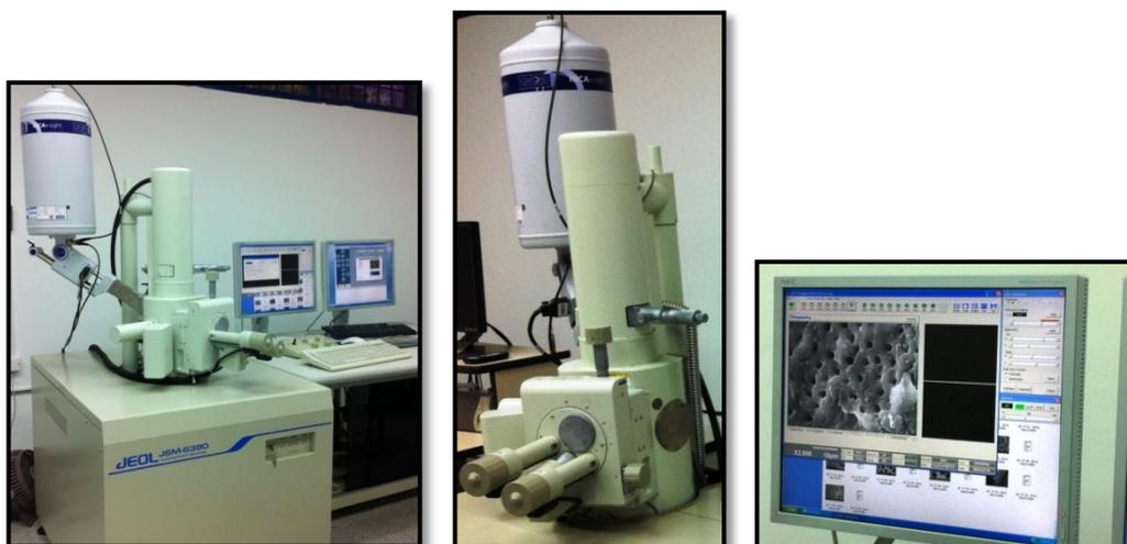
Foto 22, 23 y 24. Microscopio Electrónico de Barrido JEOL® modelo JSM-6390 de la USB. Fuente Propia por Agreda, M.
