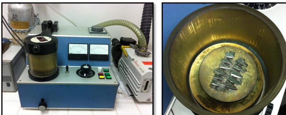
Foto 20 y 21. Recubridor iónico y *sputtering* de la muestra con Oro. Laboratorio “E” sección MEB de la USB. Fuente Propia por Agreda, M.
