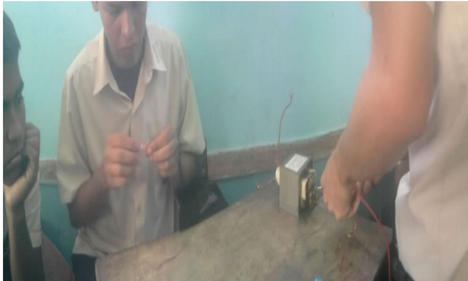
Figura 8. Conexión de conductores al Transformador
