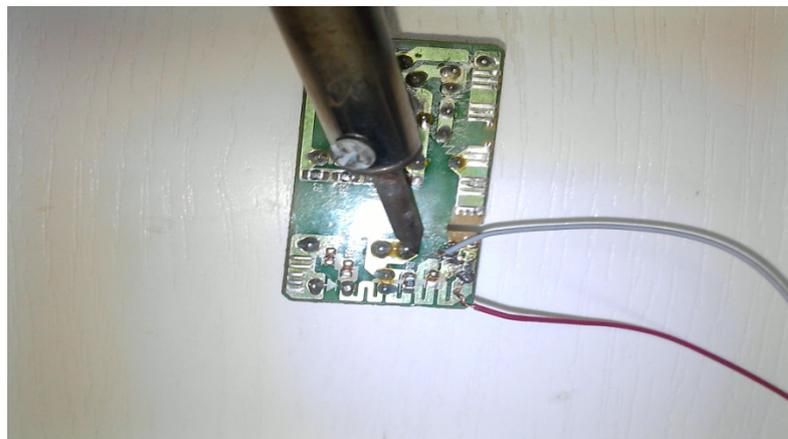
Figura 3. Soldando los conductores, mediante el caufín, a la salida del Transformador del Cargador de celular
