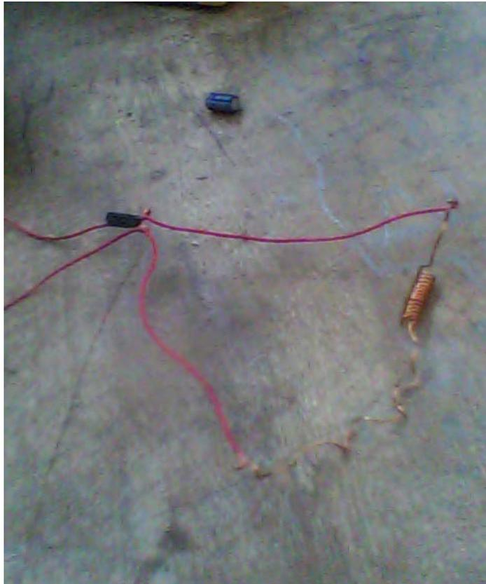
Figura 10. Conexión de bobina y condensador en paralelo, en este caso se observa que el condensador es electrolítico, el cual no es el adecuado para estos experimentos debido a su polaridad.
