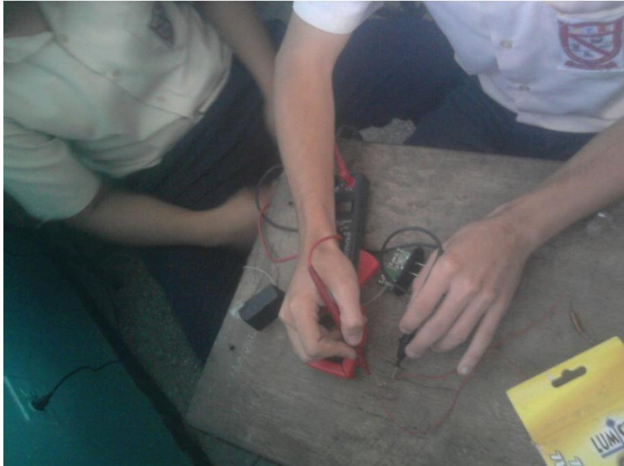
Figura 6. Haciendo pruebas referentes a la técnica de medición de Tensión, en este caso, sobre los cables conectados a la salida del Transformador del cargador.
