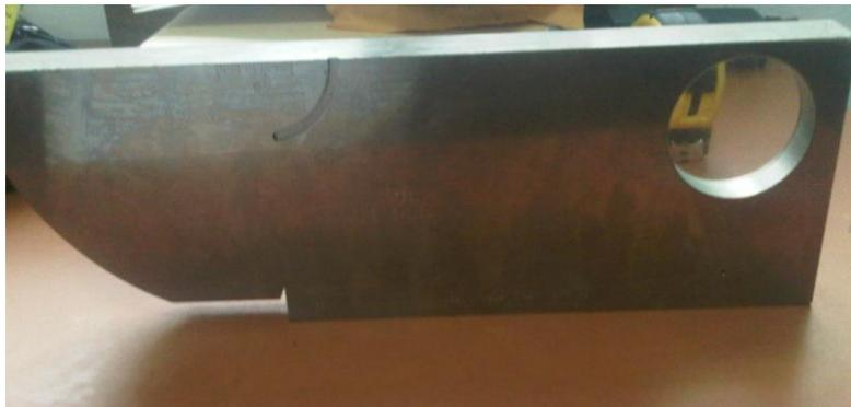
**Figura 3.8.** Bloque patrón IIW para calibración del equipo.
