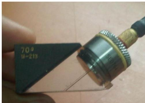
**Figura 3.6.** Palpador de haz angular de 70 °, marca Krautkramer.
