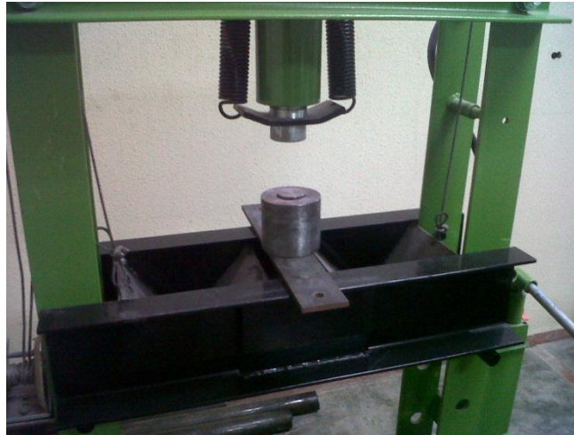
Figura 4.4.1. Proceso de compactado.
