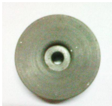
Figura 4.4.2. Base de rodillo luego del proceso de compactado.
