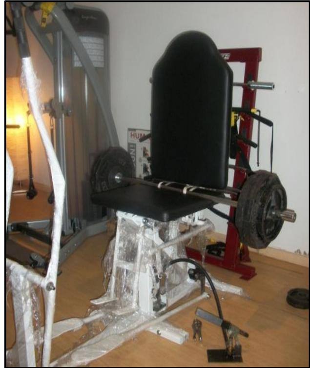
**Figura 5. 2** Prueba de cambio de posición silla a bípedo con máxima carga
