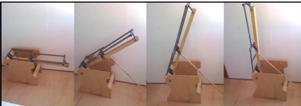
**Figura 4.8** Cambio de posición de la camilla de  $0^\circ$  a  $90^\circ$ .
