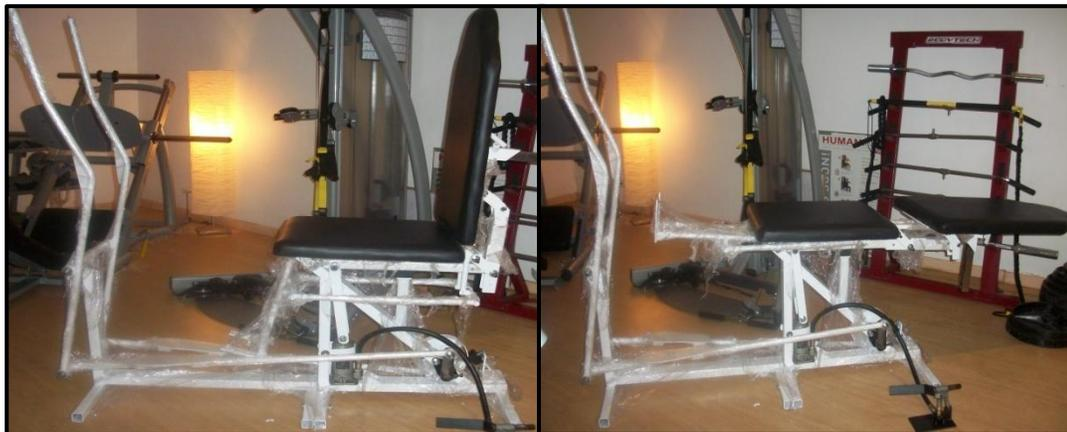
**Figura 5.3** Prueba de cambio de posición de camilla a bípedo con la carga máxima.
