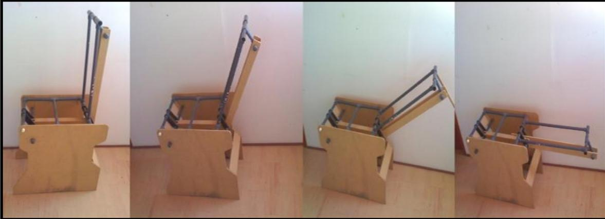
**Figura 4.7** Cambio de configuración de silla a camilla.
