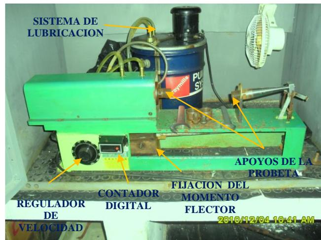
Figura 12. Máquina para Ensayo de Fatiga.
