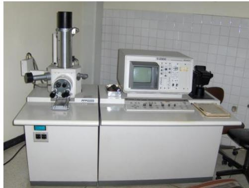
Figura 14. Microscopio Electrónico de Barrido.
