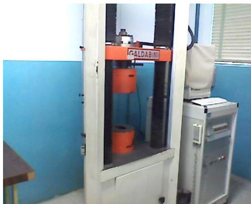
Figura 11. Máquina para Ensayo de Tracción.
