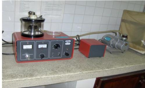
Figura 13. Ionizador o Cubridor de Iones.
