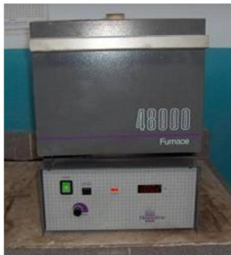
**Figura 3.4.** Horno de tratamiento térmico Thermolyne 48000 Furnace.
