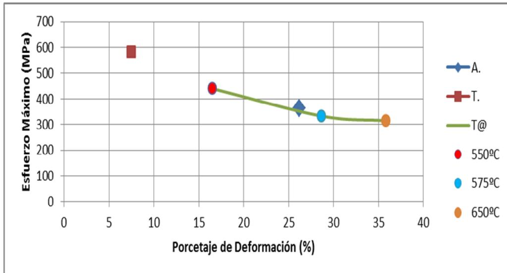
**Figura 4.22** Curva Esfuerzo Máximo vs Porcentaje de Deformación, Material de 8 mm de Diámetro.
