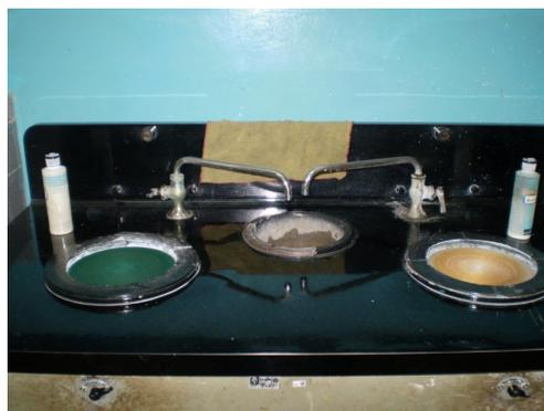
**Figura 3.7** Pulidora metalografía BUEHLER
