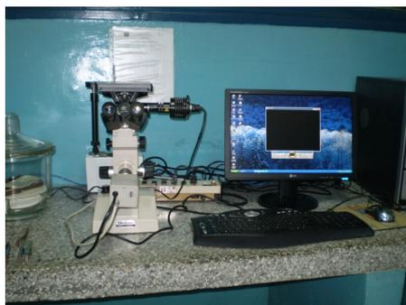
**Figura 3.9** Microscopio óptico UNIÓN.
