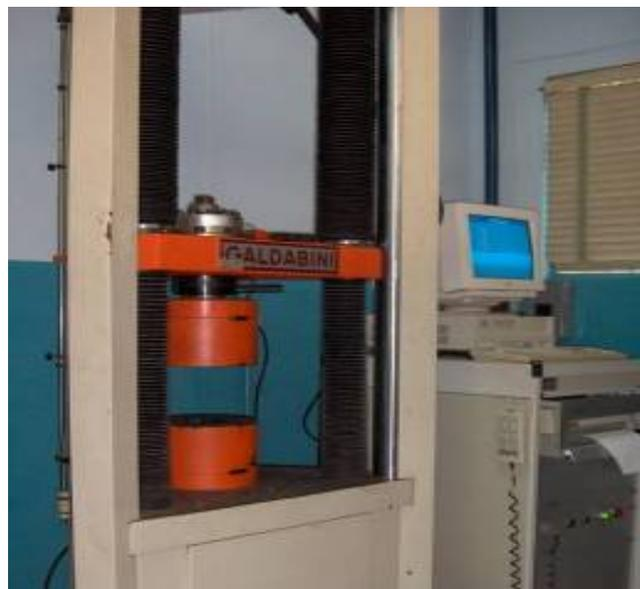
**Figura 3.3.** Máquina de Ensayo de Tracción Galdabini.
