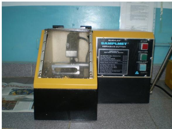
**Figura 3.5** Cortadora metalografía BUEHLER
