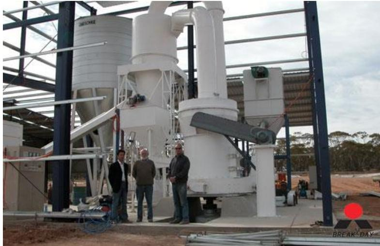
**Figura 2.10 Molino de Suspensión de Presión Alta Externo**
