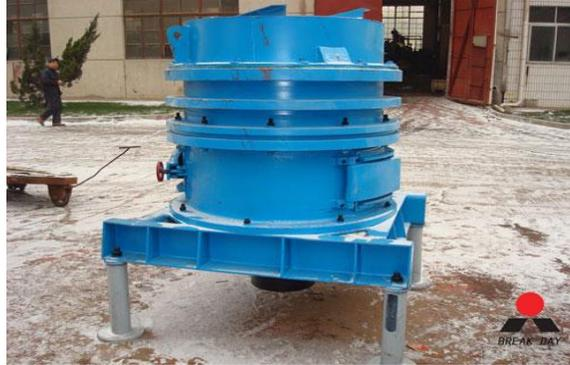
**Figura 2.14 Molino de Rodillos MSB.**
