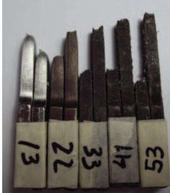
Figura 4.6: Pérdida de material superficial en las probetas de tracción.
