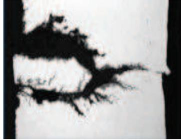
Figura 2.7: Corrosión bajo esfuerzos. Fuente: (Echeverría. 2010).
