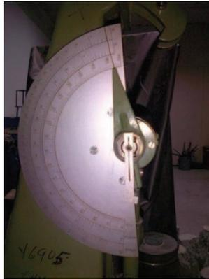
Figura 3.17: Resultado de la energía absorbida por impacto sin muestra alguna
