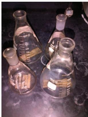
Figura 3.10: Probetas de tracción e impacto colocadas dentro de los matraces Erlenmeyer
