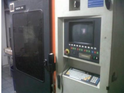
Figura 3.5: Cortadora de electroerosión por hilo.
