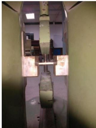
Figura 3.18: Alineación entre la entalladura y el impactómetro.
