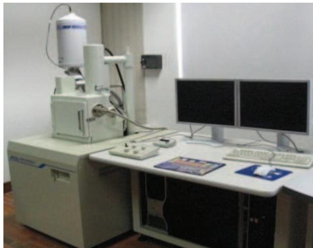
Figura 3.25: Microscopio electrónico de barrido, con detector de EDX incorporado.
