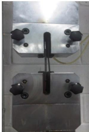
Figura 3.21: Ubicación de la probeta en la máquina de ensayo electromecánica.
