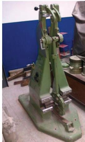
Figura 3.20: Máquina de ensayo de impacto FRANK
