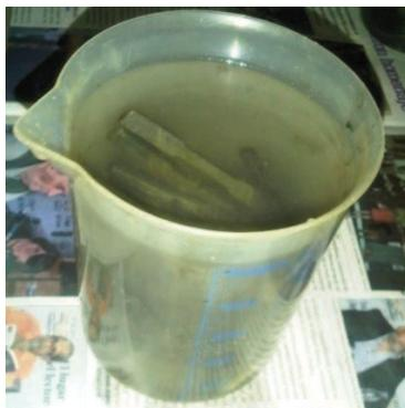
Figura 3.14: Limpieza química de las probetas
