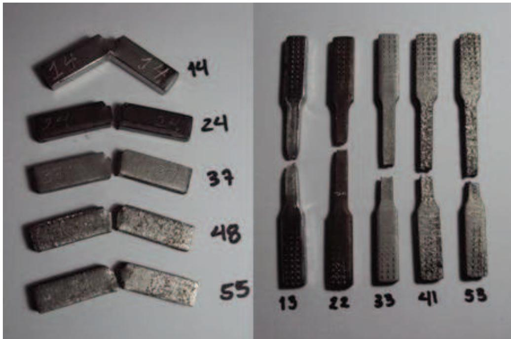
Figura 4.5: Pérdida de material superficial en las probetas de tracción e impacto.
