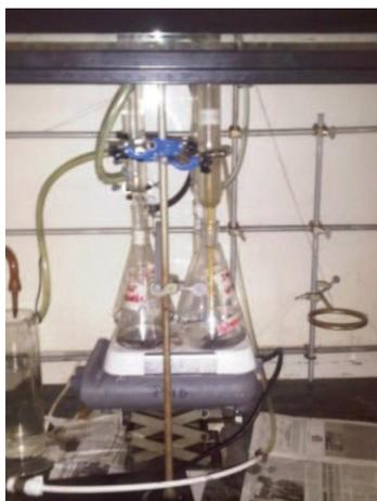
Figura 3.11: Montaje para el exposición en ácido clorhídrico.
