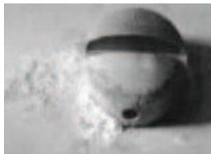
Figura 2.9: Perno de Acero Inoxidable 316 que ha causado una corrosión galvánica de una plancha de aluminio después de 6 meses de exposición a la atmósfera. Fuente: (Echeverría, 2010).
