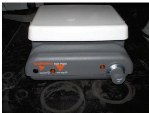
Figura 3.16: Plancha de calentamiento
