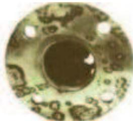
Figura 2.8: Corrosión en grietas. Fuente: (Echeverría. 2010).
