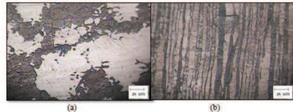
Figura 4.23: Muestra de acero dúplex 2205 condición 72 horas, a 400X microscopio óptico.
