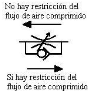
**Figura 2.12.** Representación simbólica de una válvula reguladora unidireccional.
