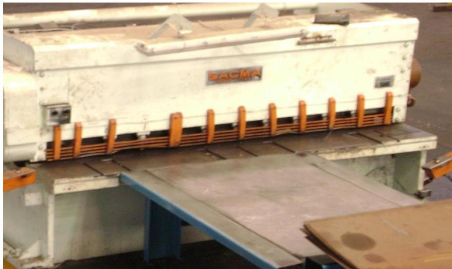
**Figura 2.2.** Máquina cortadora
