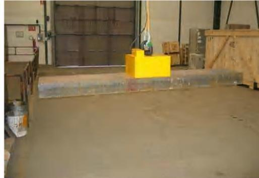
El electropermanente EPC-37 permite manejar todo tipo de piezas con la única acción de sus imanes permanentes. Su maniobra de imantar-desimantar se realiza por la acción de un breve impulso de corriente. El transporte de la carga se realiza sin ningún aporte de energía eléctrica.
