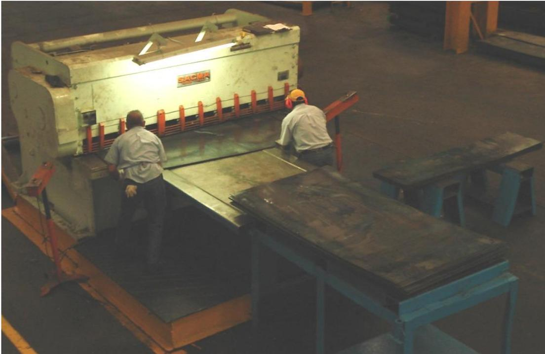
**Figura 1.1.** Alimentación de maquina cortadora realizada por dos operadores.
