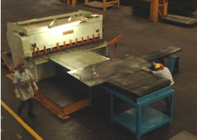
**Figura 4.1** Detalle de la máquina y proceso de corte de la guillotina
