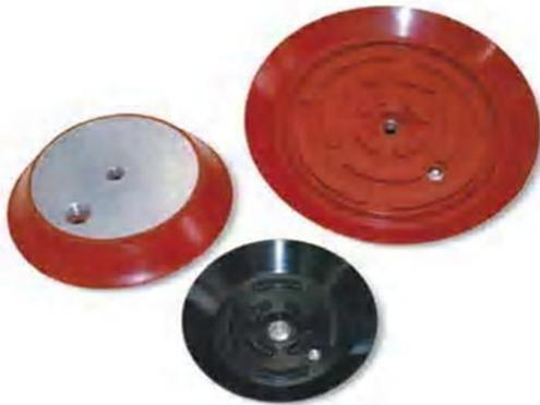
Esta línea de ventosas ha sido concebida para la elevación y la manipulación horizontal y vertical de grandes cargas. Vulcanizadas en un soporte de acero, tienen un orificio roscado central para su fijación al automatismo y uno lateral para la conexión de vacío.
