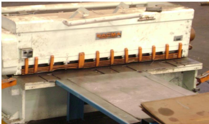
Figura 2.2. Máquina cortadora
