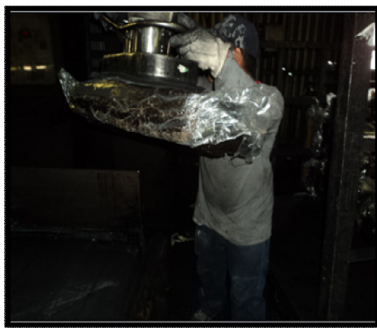
Figura Nro. 9. Carga con elevador por vacío.
