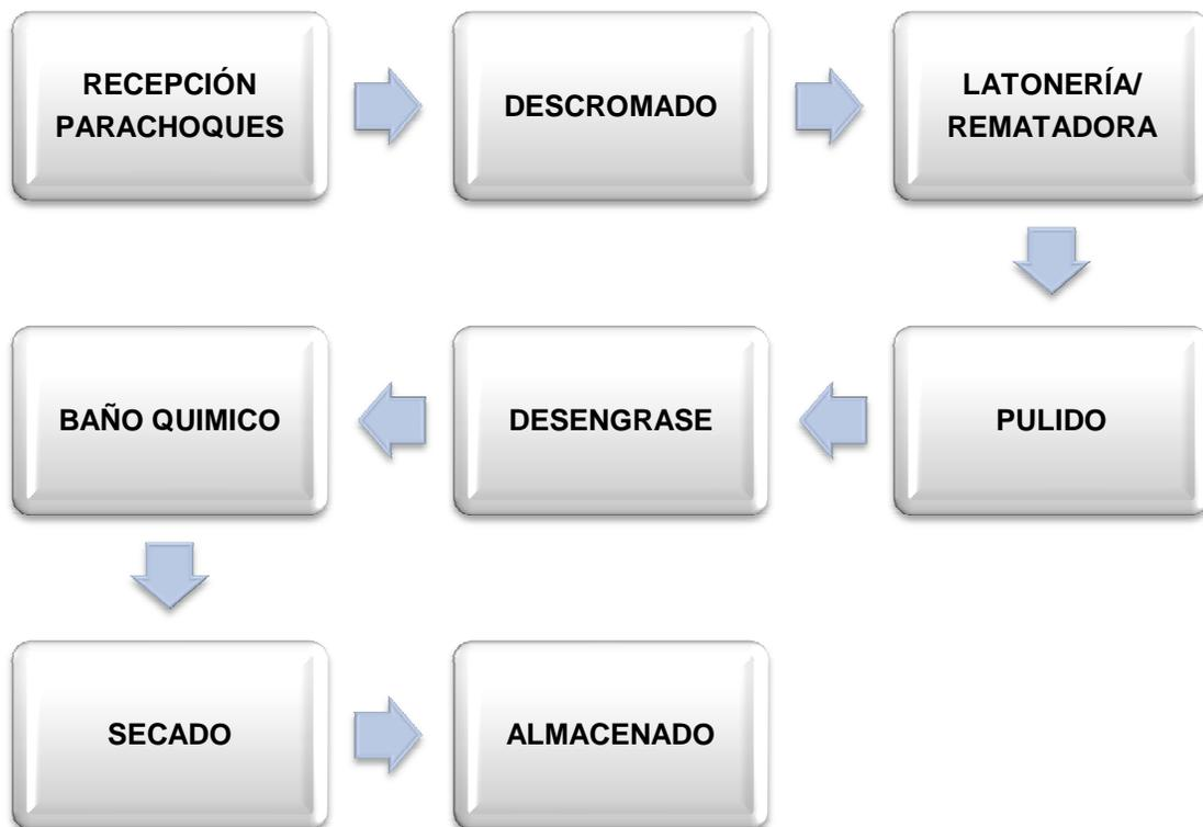
Figura N°4: Diagrama de operaciones de Galvanizado de parachoques
