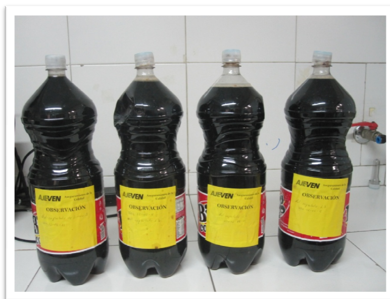
Figura 23: botellas mal capsuladas
