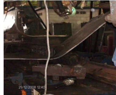
Una vez alcanzada la curvatura se colocan en posición los rodillos de contrafuerza.
