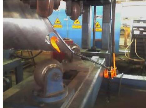
17. Dos operarios deben posicionar los rodillos del primer pórtico para fijar la alineación del tubo con respecto al bastidor de salida.
