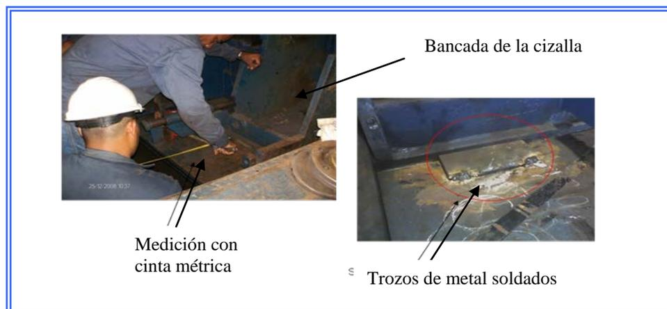
**Figura 3.13:** Desplazamiento de las cizallas
