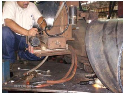
El stickout, (extensión del alambre) debe ser aproximadamente de 1 pulgada. La antorcha de soldadura debe tener un ángulo de inclinación de 10° a 15° con respecto a la vertical y en el sentido contrario a la rotación del tubo, también debe existir un desplazamiento aproximado (d) del la punta del electrodo como se muestra en la figura.
