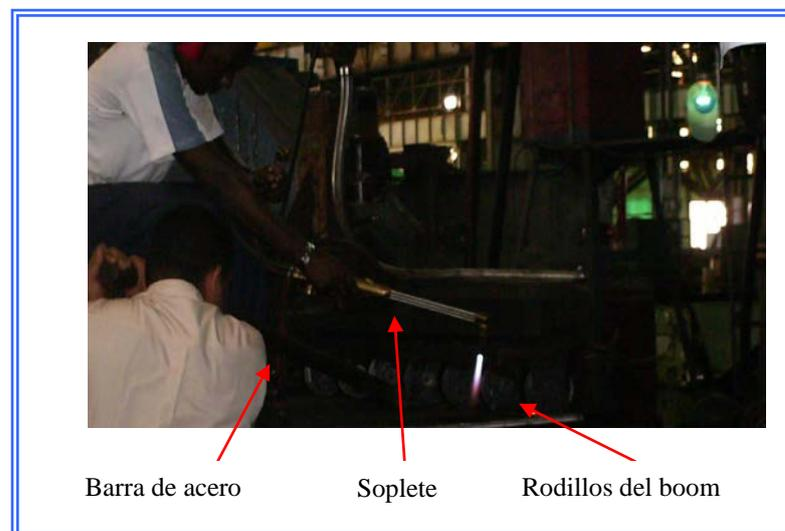
**Figura 3.17:** Introducción de la lámina entre rodillos de entrada y del boom.
