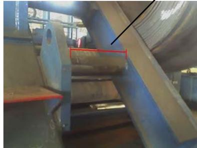
La bobina se desplaza a los lados mediante mordazas accionadas por cilindros hidráulicos que permiten al operador alinear el centro de la bobina con el del bastidor de entrada.
