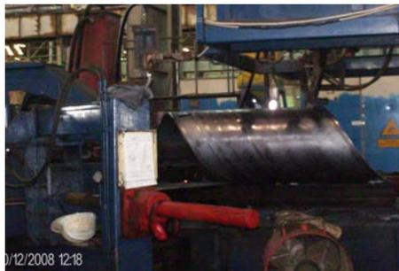
15. Avanzar la banda, soldar internamente sobre el inversor en pasos de no más de 100 mm, medir el perímetro.
